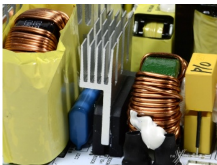
Particolare del doppio ponte raddrizzatore dissipato da un elemento in alluminio dedicato.
