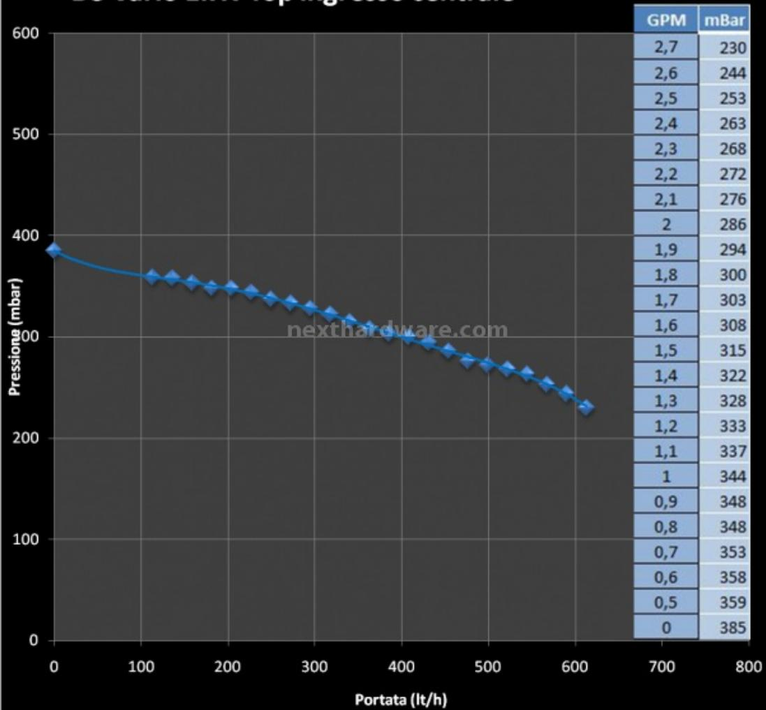
Curva caratteristica di una D5 Vario con X-Top EK montato. In questa rilevazione abbiamo installato i raccordi usando la stessa disposizione del top originale.
