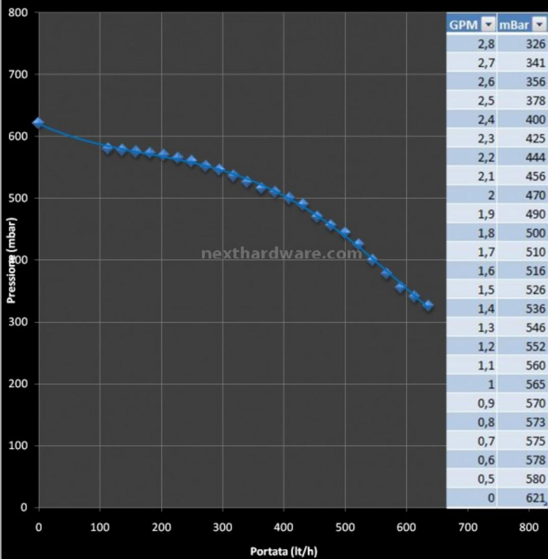
Curva caratteristica di due Laing DDC3.1 con EK Dual Turbo Top installato.
