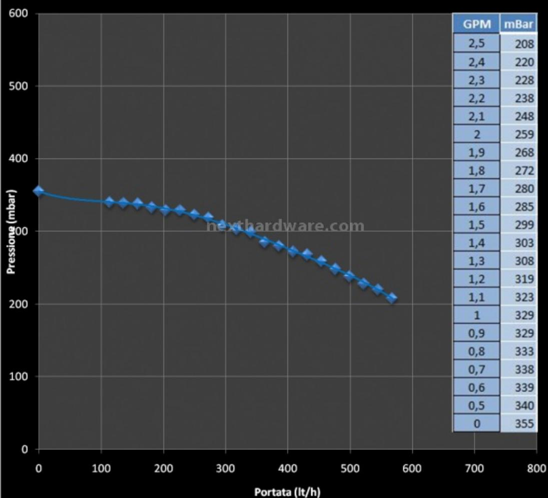
Curva caratteristica di una D5 Vario con X-Top EK montato. In questa rilevazione abbiamo installato entrambi i raccordi sulla parte alta del top.
