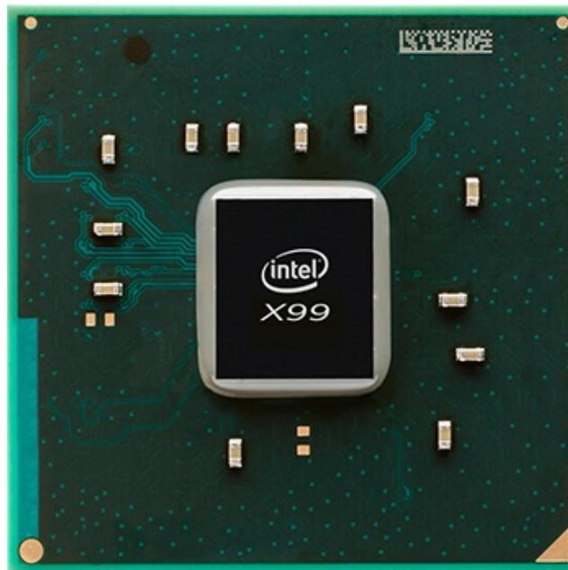
Il chipset Intel X99 è connesso alla CPU tramite l'ormai tradizionale BUS DMI 2.0, operante in modalità 4x, per una banda complessiva di 20 Gb/s.
