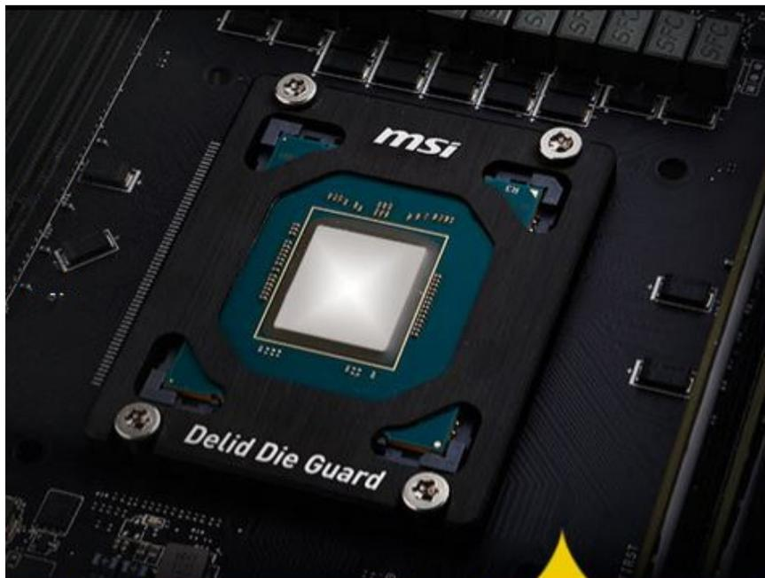
Come potete osservare, l'accessorio forma una speciale cornice che impedisce al dissipatore, o ad un eventuale contenitore per azoto, di oscillare durante la fase di montaggio, provocando l'inevitabile scheggiatura dei bordi della CPU scoperta.
