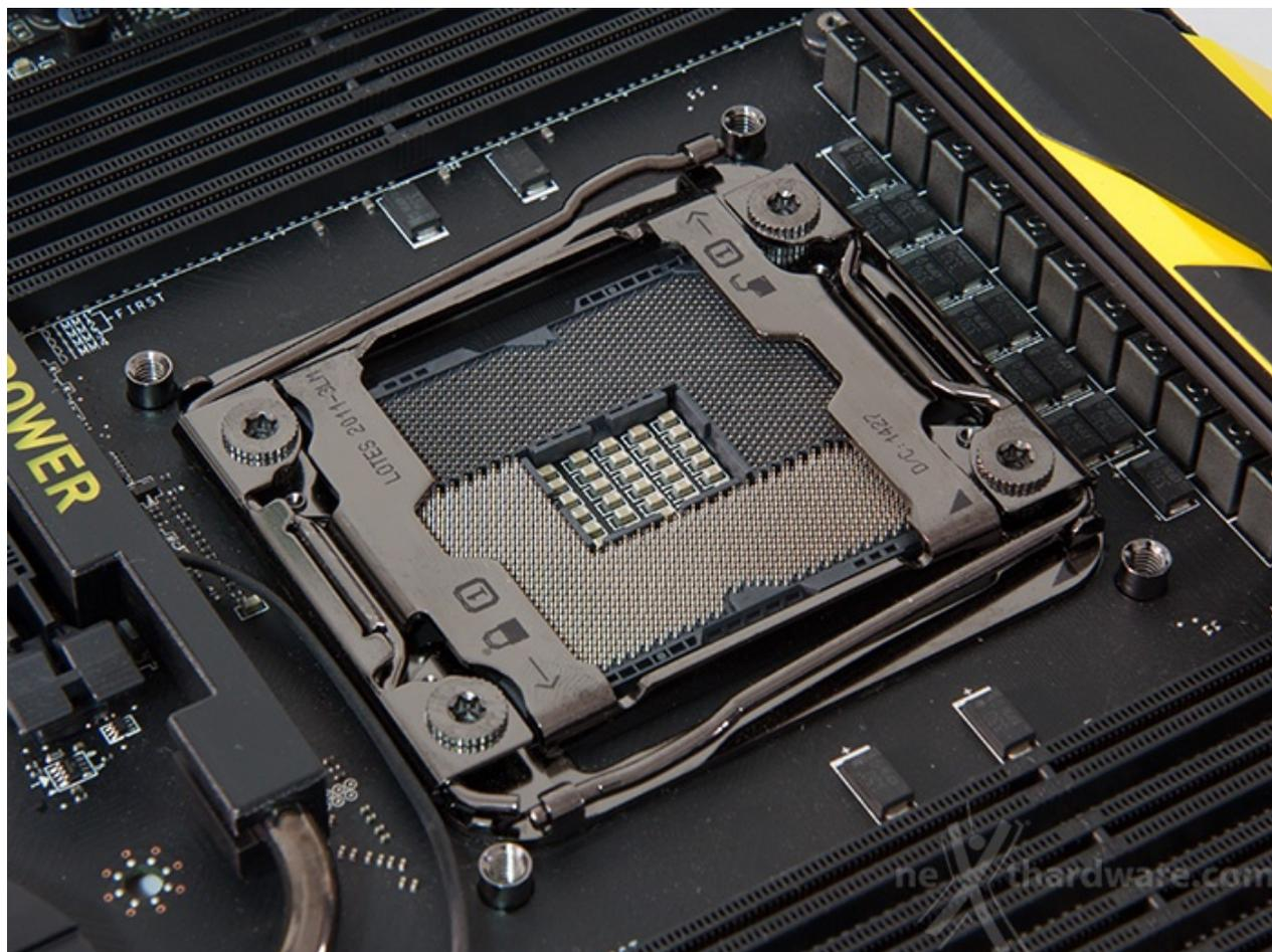
A dispetto del nome, il nuovo socket non è né meccanicamente, né elettricamente, compatibile con quello impiegato per le CPU della serie 4000 e 3000, rendendo di fatto necessaria la sostituzione della scheda madre, oltre che delle tradizionali DDR3 con i nuovi moduli DDR4, per procedere con l'upgrade alla nuova piattaforma.
