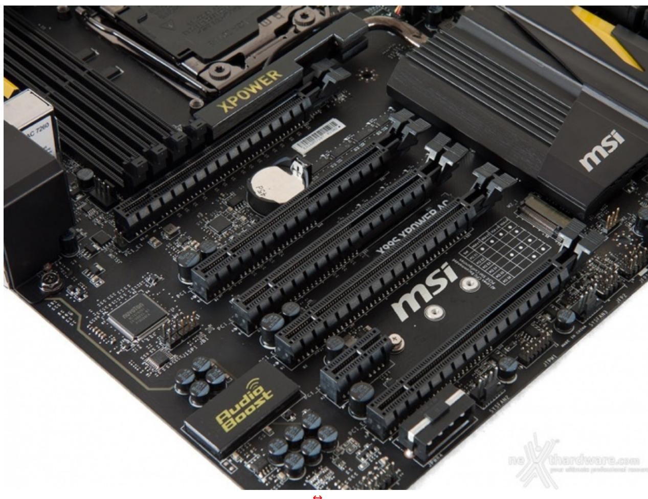
Nella foto in alto possiamo osservare i cinque slot PCI-E 16x 3.0 e l'unico PCI-E 1x conforme allo standard 2.0.
