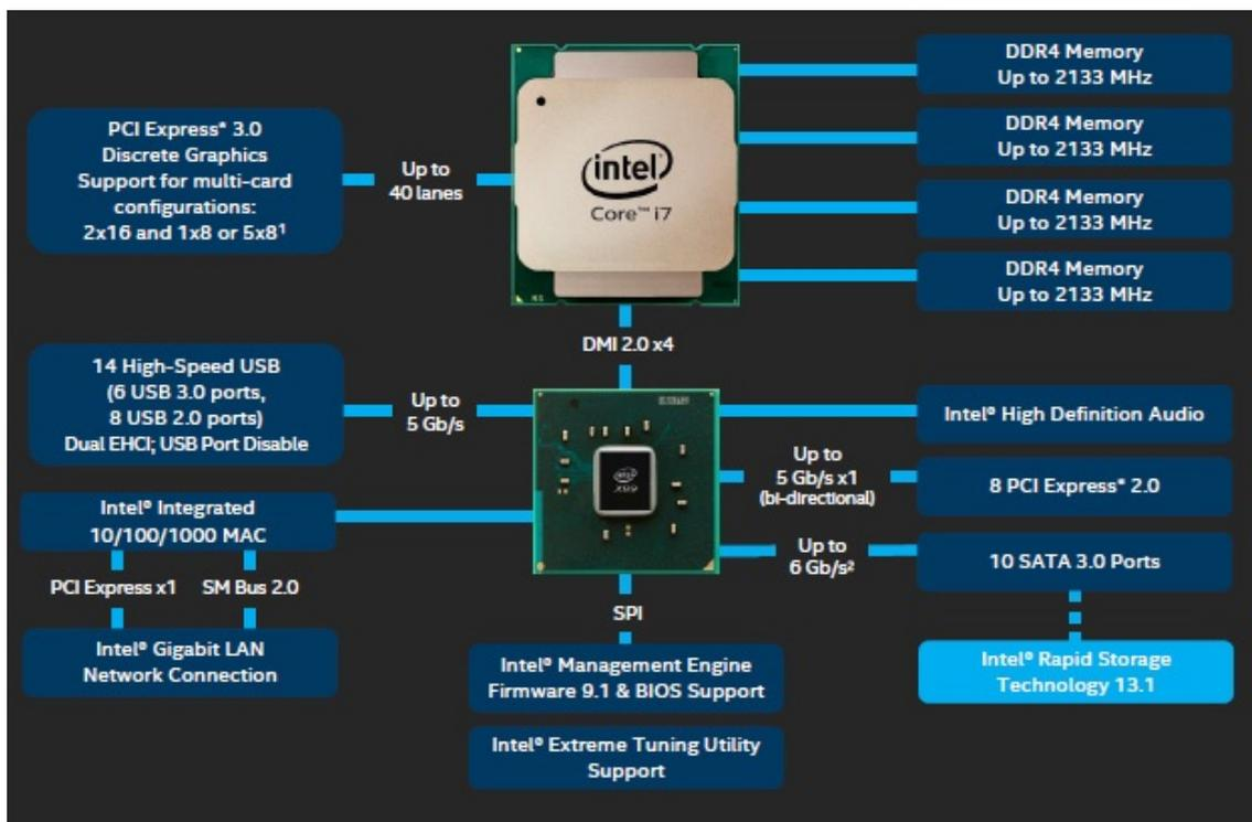
Per il collegamento alle periferiche esterne, ed in particolare alle schede video, Intel ha scelto di integrare all'interno della CPU un controller PCI-E 3.0 dotato di 40 linee per i modelli i7-5960X e i7-5930K e di 28 linee per il modello i7-5820K.
