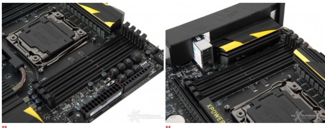
Il comparto dedicato alle memorie prevede otto slot DIMM, tutti di colore rigorosamente nero, in grado di ospitare fino 128GB di memoria DDR4 in configurazione quad channel con una frequenza massima teorica di 3333MHz.
