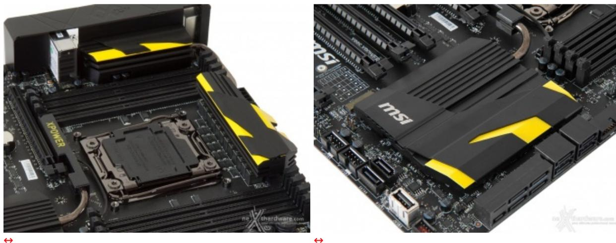
Tutti i dissipatori sono dotati di parti alettate più o meno accentuate per favorire lo smaltimento del calore tramite i flussi d'aria che generalmente investono tale zona.
