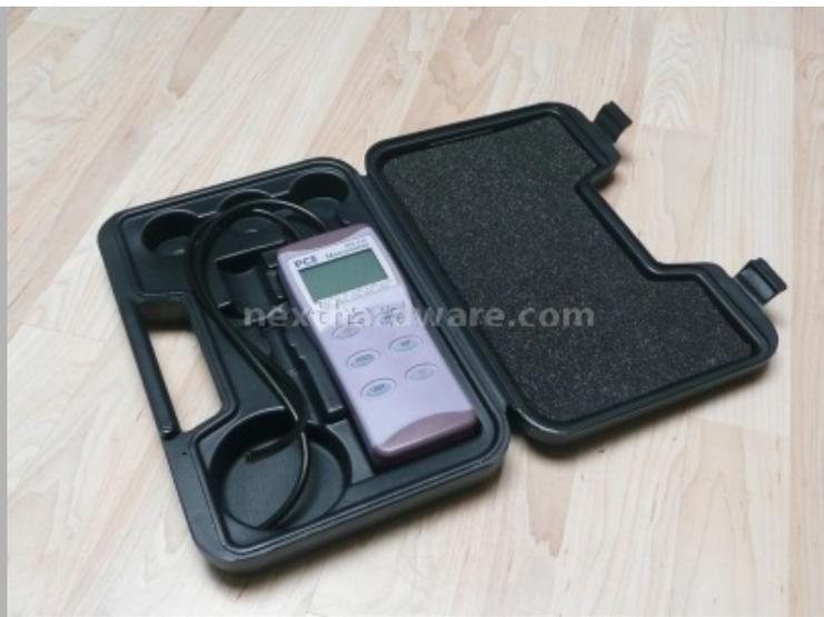
Per svolgere i test di portata abbiamo utilizzato un manometro differenziale digitale PCE P30 (sopra) ed un flussimetro King Instrument (in foto a sx).
