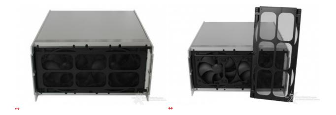
Si avrà così accesso alla zona inferiore vera e propria, composta da un grande filtro antipolvere calamitato, riposto a protezione delle due performanti ventole Air Penetrator da 180mm.
