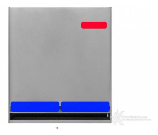
Il sistema di raffreddamento interno del SilverStone Fortess FT05 sia avvale, di serie, di due sole ventole da 180mm installate sul fondo, alle quali può esserne aggiunta una opzionale da 120mm sul top.
