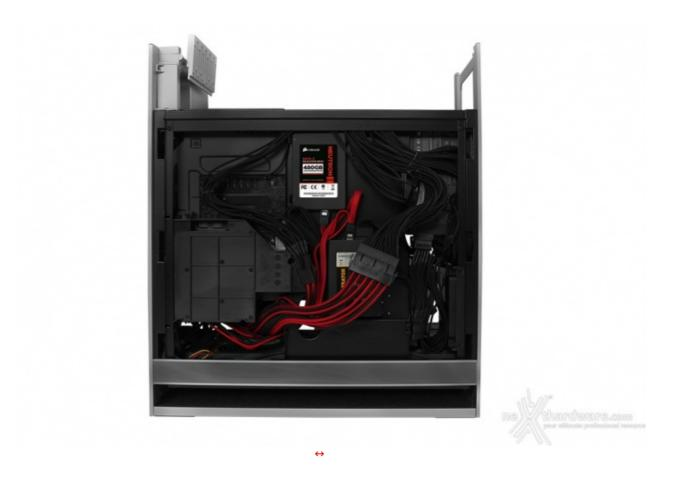
Il cablaggio è abbastanza semplice e sulla parte destra del case si potranno "nascondere" tutti i cavi necessari ...
