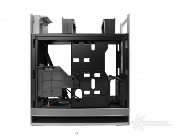
Dietro di esso sarà possibile montare due drive da 2.5" ed un lettore ottico di tipo slot-in.
