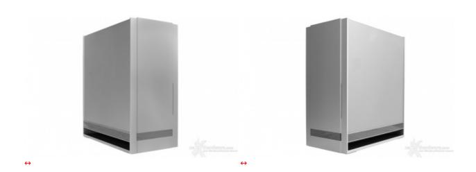
Lateralmente, il Fortess FT05 rispecchia il design del frontale riproponendo superfici lisce e pulite, completamente prive di dettagli fatta eccezione per la striscia lucida sotto cui è situata l'apertura longitudinale attraverso la quale verrà pescata l'aria dalle due poderose Air Penetrator da 180mm viste in precedenza.
