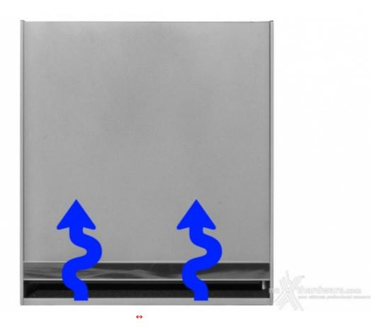
Tale sistema, seppur apparentemente limitato, è studiato ad hoc per integrarsi con la disposizione ruotata dell'hardware e sfruttare a pieno il principio della pressione d'aria positiva, nel quale il flusso d'aria calda tende naturalmente a convergere verso l'alto.
