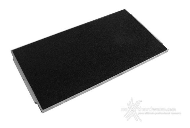
Una volta rimosso potremo analizzarne la parte nascosta, dotata di un ampio foglio di materiale fonoassorbente.
