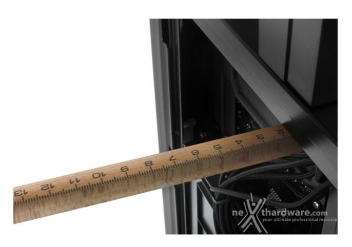
La distanza teorica tra il pannello ed il piatto mainboard ammonterebbe 17mm, ma bisogna anche tener conto dello spessore di circa 5mm del foglio di materiale fonoassorbente e del suo grado di comprimibilità .
