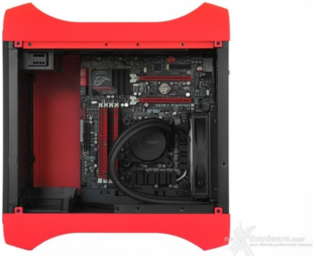
Per montare il radiatore da 140mm del sistema di raffreddamento a liquido, abbiamo usato la predisposizione presente sul retro del case, rimuovendo la ventola in dotazione da 120mm.
