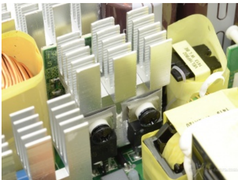
Particolare dello stadio primario di switching.
