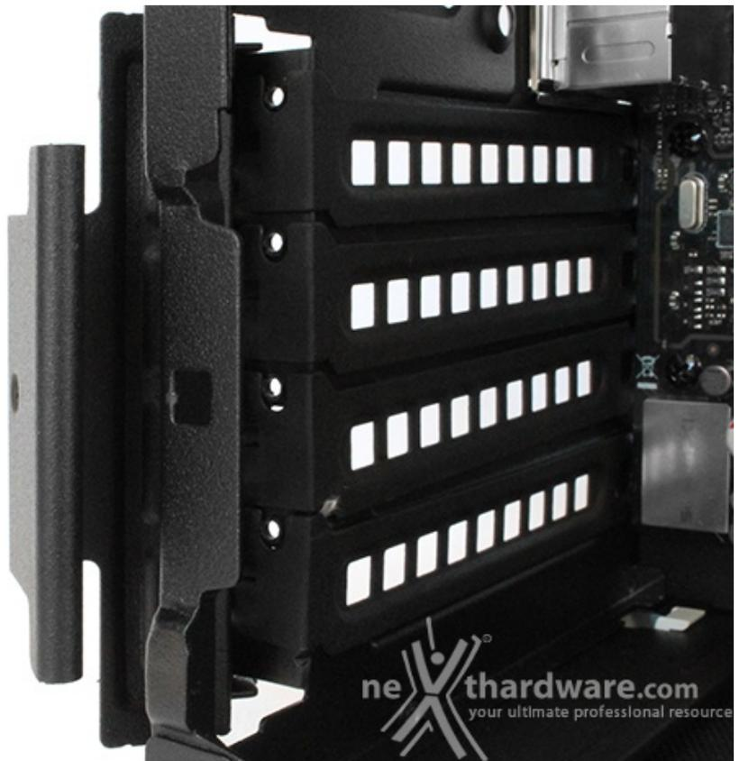
Un particolare molto interessante risiede nel fatto che, per montare le schede PCI-E, non saranno necessari strumenti o viti (salvo casi particolari), poichè il case dispone di un sistema a sgancio rapido molto comodo, costituito da un unico grande e robusto gancio.
