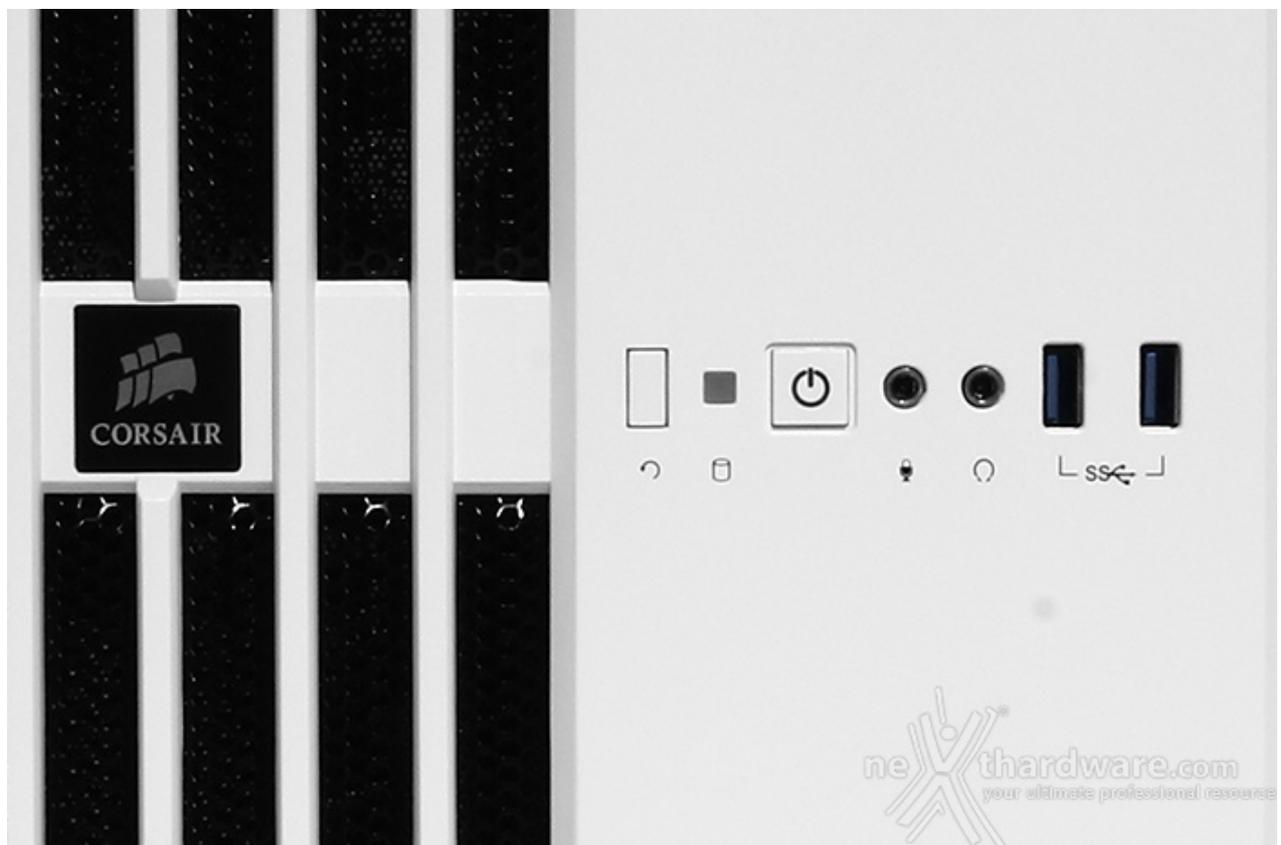
Il pannello delle connessioni è integrato nella parte destra del frontale e prevede, partendo da sinistra, il pulsante di reset, il LED di attività dei drive, il pulsante d'accensione con relativo LED di stato, due connettori jack audio e, infine, due porte USB 3.0.
