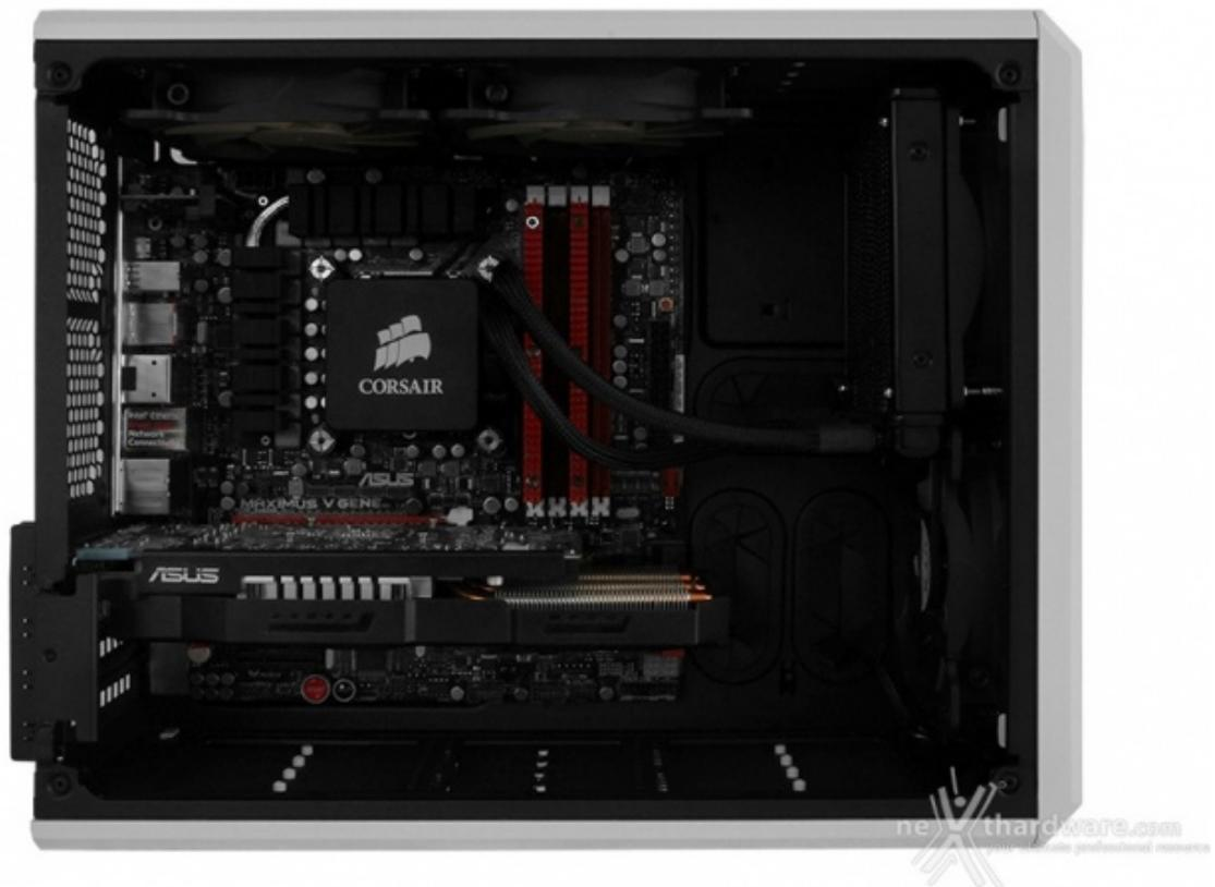
Proseguendo, abbiamo montato la scheda video che, nonostante la lunghezza del dissipatore, è stata facilmente inserita sullo slot PCI Express superiore.
