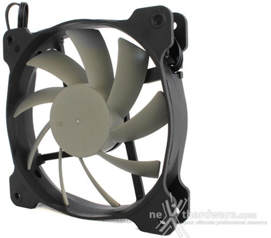
Le ventole A1225L12S-2 da 120mm fornite in dotazione sono le stesse con connettore 3 pin che abbiamo già visto sul Graphite 380T e su tutti gli ultimi case di casa Corsair, nello specifico la seconda revisione di quelle utilizzate per i vecchi Obsidian.
