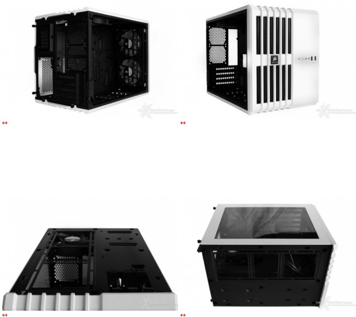
Ma, come abbiamo visto precedentemente, in caso si debba installare una configurazione piuttosto spinta, ci vengono in aiuto le predisposizioni presenti sul fondo del case, dove, lo ricordiamo, è possibile installare due ventole opzionali da 120mm.
