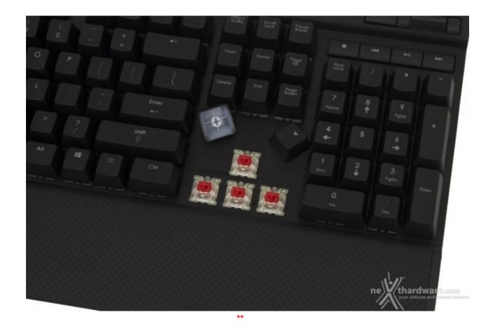
Questa è sicuramente la prima volta, qui in Nexthardware, che abbiamo a che fare con un "vero" MX RGB, con case in plastica trasparente e LED a montaggio superficiale, direttamente saldato sulla matrice della scheda.
