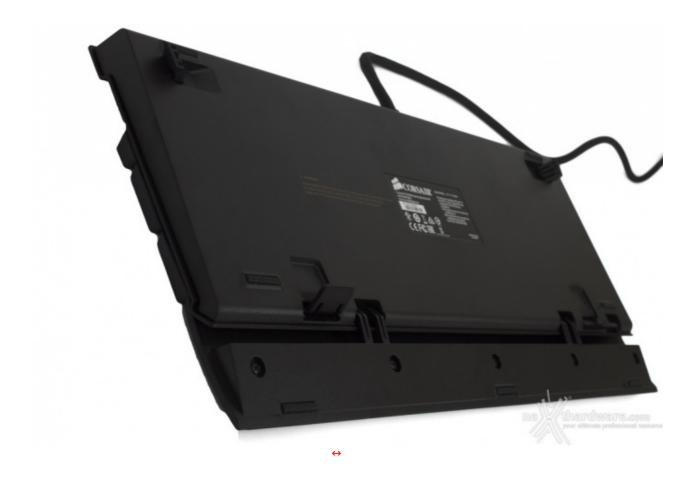
In alto possiamo osservare la parte inferiore della tastiera costruita in plastica, dove troviamo i supporti di regolazione per l'altezza della stessa.
