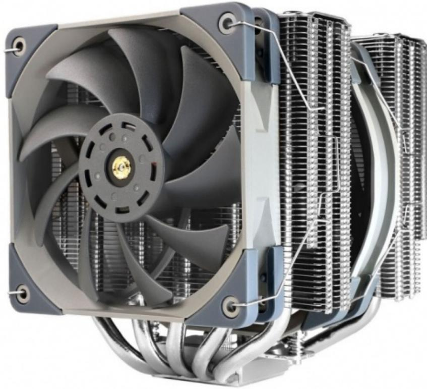
Le ventole incluse sono due FDB di diverse dimensioni: quella frontale è una TL-C12 (120mm) con una velocità massima di 1800 RPM, un flusso di aria di 82 CFM, una pressione statica di 2,10 mm H<sub>2</sub>O ed una rumorosità sino a 29,6 dBA, mentre quella interna alle due torri è una TL-D14X (140mm) da 1800 RPM con un flusso d'aria massimo di 95,50 CFM, una pressione statica di 2,25 mm H<sub>2</sub>O ed una rumorosità sino a 30,2 dBA.
