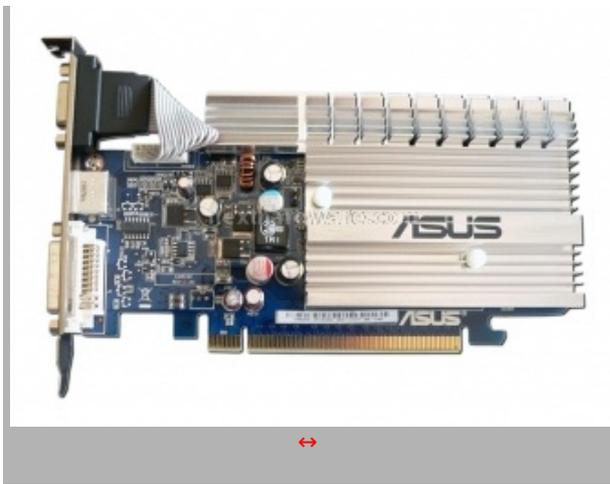
Date le scarse necessità energetiche della GPU GeForce 8400 GS, ASUS ha deciso di optare per una soluzione di raffreddamento completamente passiva.
