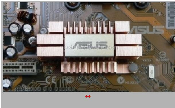
Il chipset, NVIDIA GeForce 8200, è raffreddato passivamente da un piccolo dissipatore metallico.
