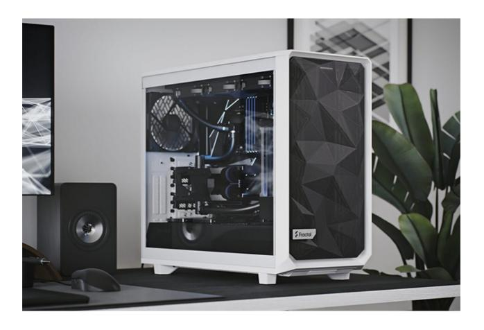
Tutte le predisposizioni per ventole, inoltre, possono essere utilizzate per l'installazione di radiatori facenti parte di sistemi di raffreddamento a liquido custom o AiO; sul top ne può essere montato uno da 420mm, nella parte bassa uno da 280, frontalmente uno da 360 e sul retro uno da 120mm.
