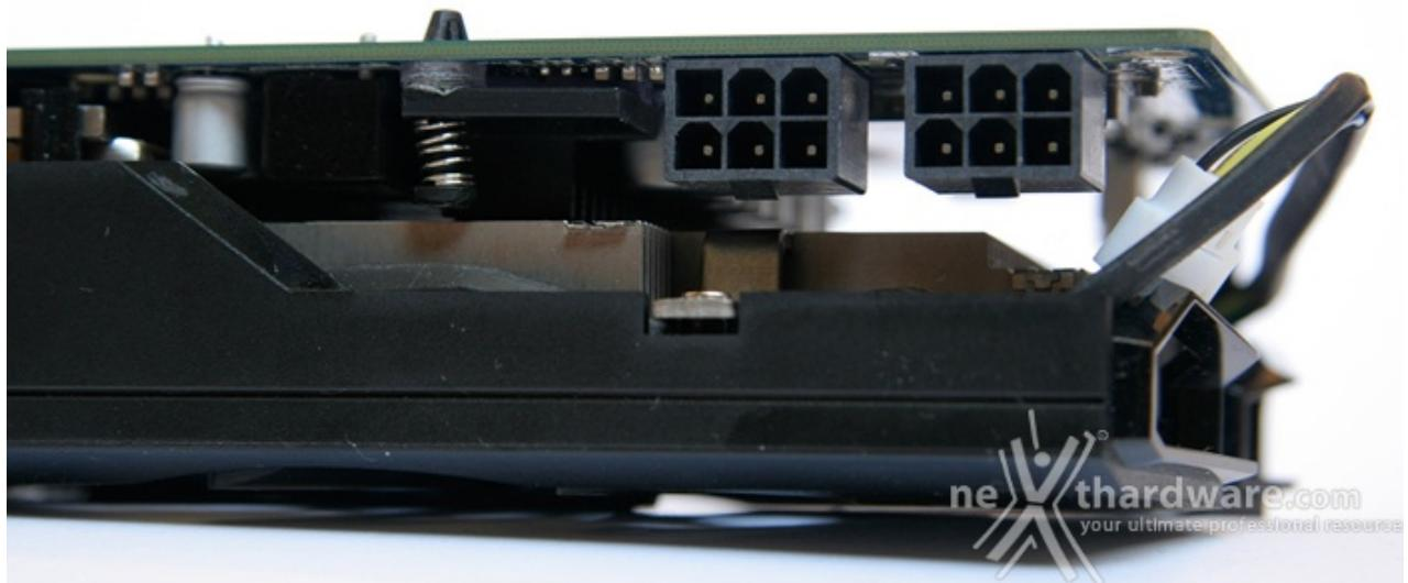
Dulcis in fundo, il particolare dei due connettori di alimentazione PCI-E a 6 pin richiesti dalla scheda per garantire i 225W di assorbimento massimo dichiarati.
