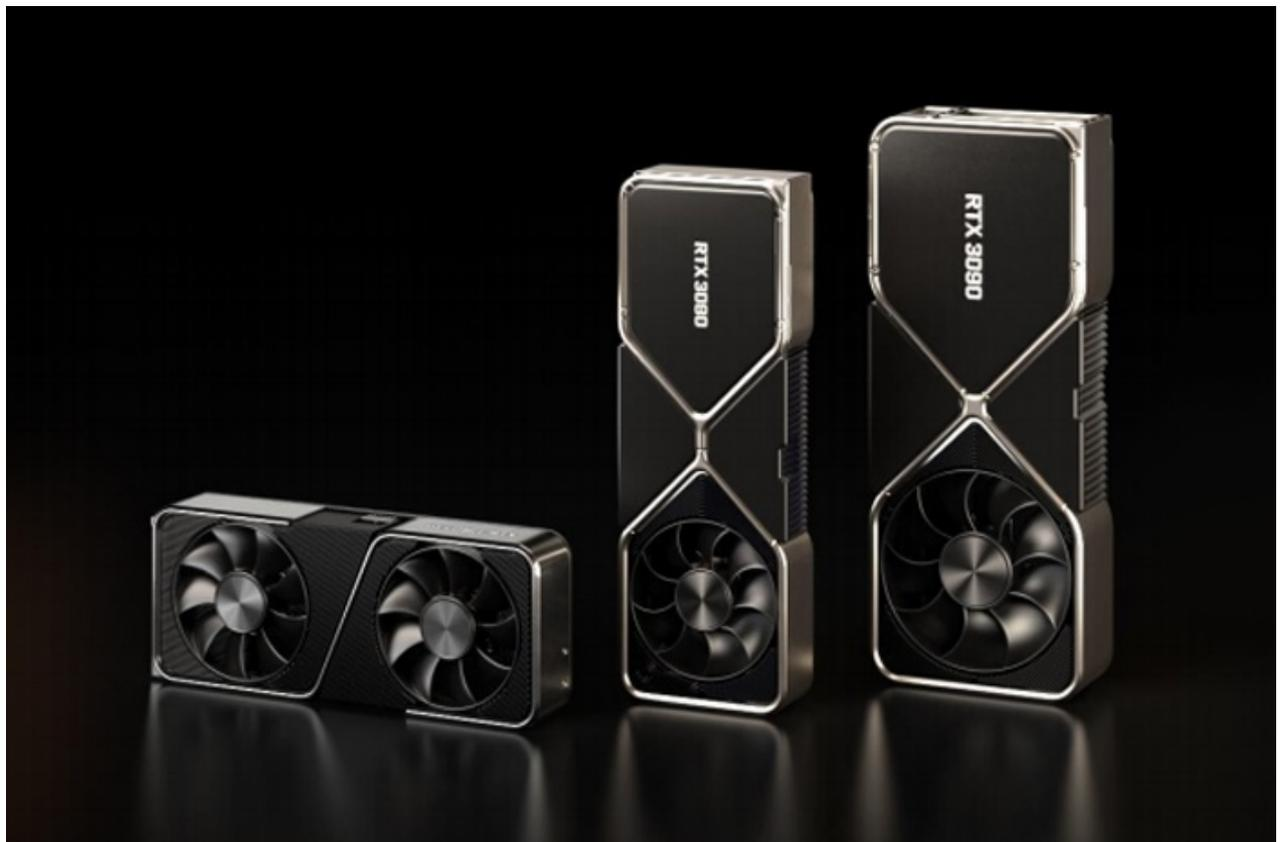
La **seconda generazione RTX** rappresenta un diretto salto evolutivo rispetto alla precedente, rimane invariato il tritico CUDA core, Tensor core e RT core e viene moltiplicata la quantità di operazioni in virgola mobile al secondo (FLOPS).
