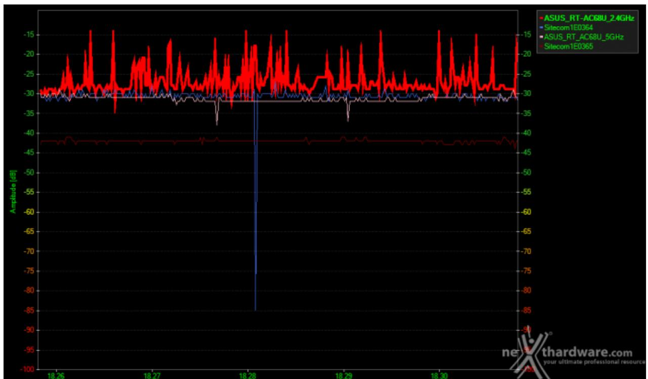
Effettuando la stessa rilevazione con la ASUS PCE-AC68, il router in prova vince nettamente il confronto con la controparte nella banda da 5GHz, dove mantiene una potenza costante di circa↔ 31dB, contro i 42dB del Sitecom.
