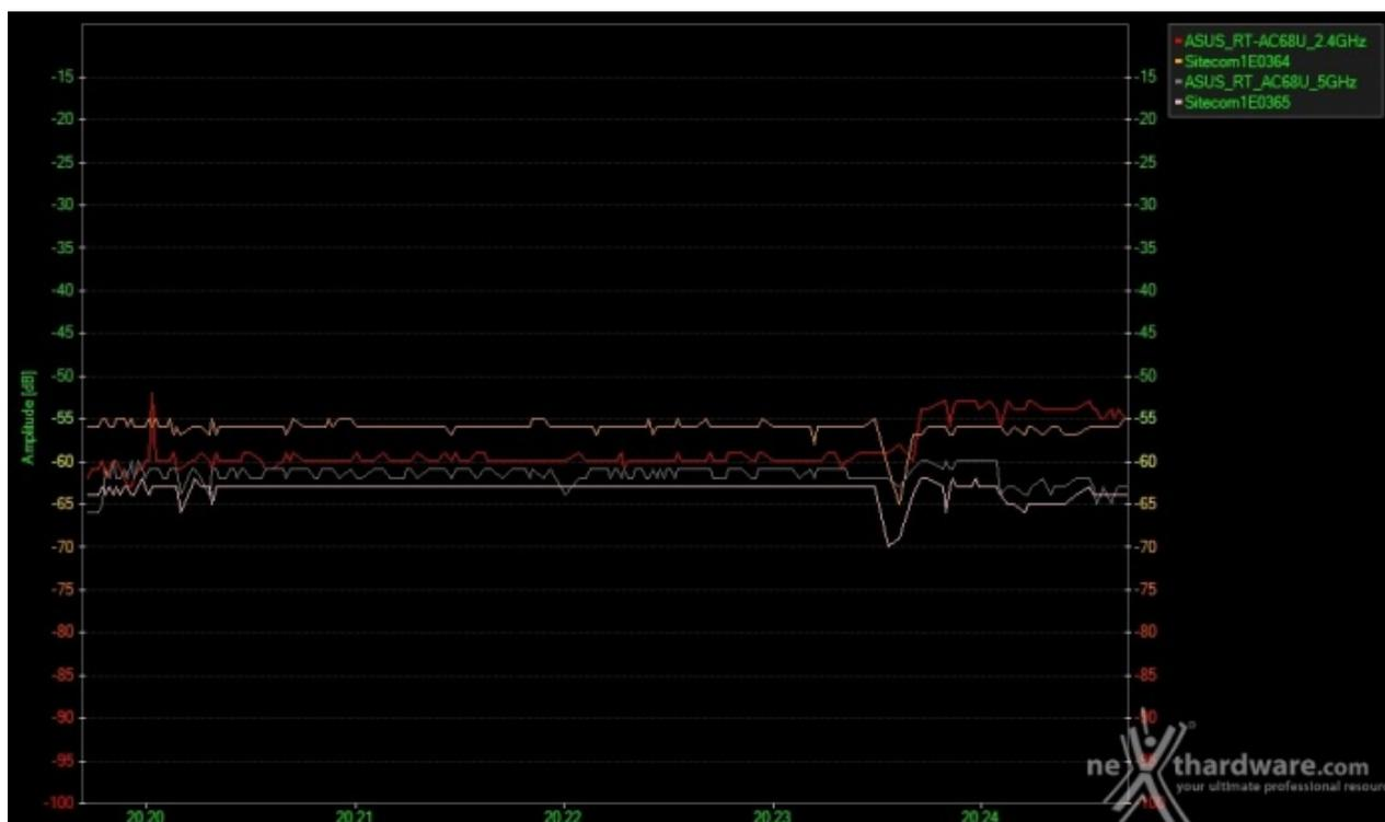
Nei test effettuati a 10mt con presenza di ostacolo, utilizzando la PCE-AC68, notiamo per la prima volta il Sitecom X8AC1750 prevalere sulla banda da 2.4GHz per un intervallo di tempo di circa tre minuti, trascorso il quale l'ASUS RT-AC68U sembra riaffermare la propria supremazia, che invece rimane sempre indiscussa sulla banda da 5GHz.
