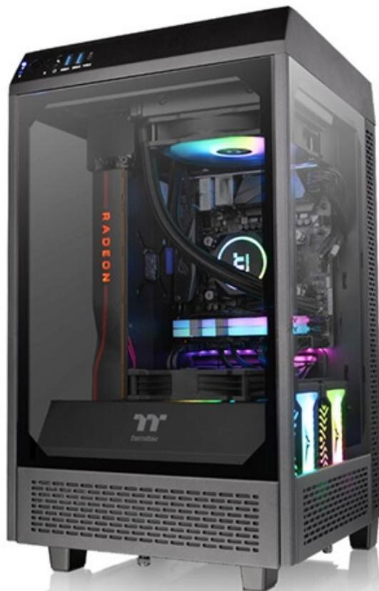
Realizzato in acciaio e con tre pannelli in vetro temperato, il nuovo case è in grado di contenere una scheda madre in formato Mini-ITX, una scheda video lunga 320mm, due drive da 2,5" o 3,5" ed un alimentatore in formato ATX.
