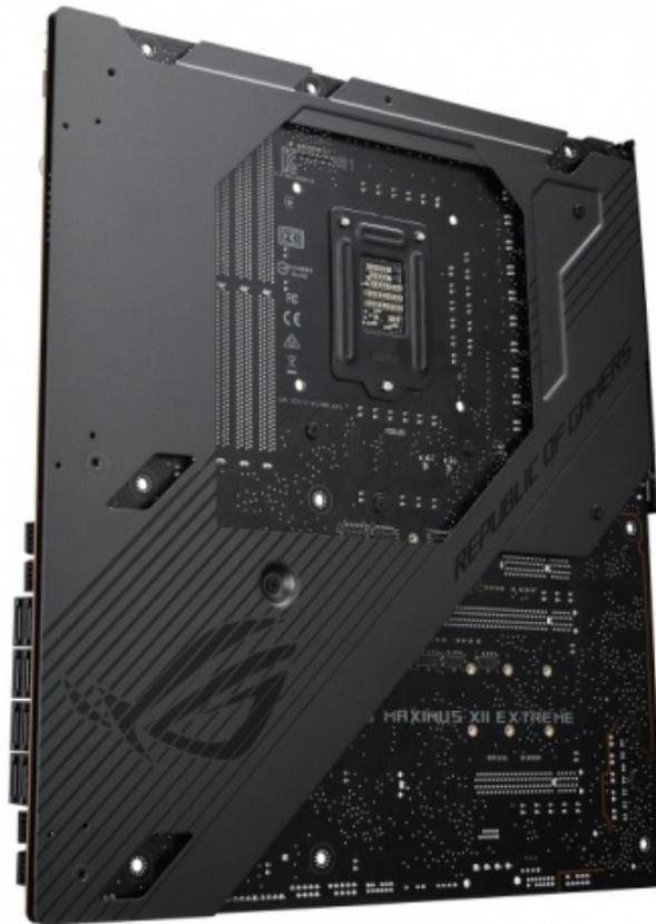
Quattro sono gli slot DIMM con tecnologia OptiMem III e topologia di tipo Daisy Chain, in grado di ospitare sino a 128GB di DDR4 con frequenza massima di 4800MHz (OC), ma è anche presente uno slot per un modulo ROG DIMM.2 che consente di installare altri due drive M.2 in aggiunta a quelli eventualmente utilizzati sui due slot M.2 disponibili direttamente sulla scheda e situati sotto l'armatura in alluminio.
