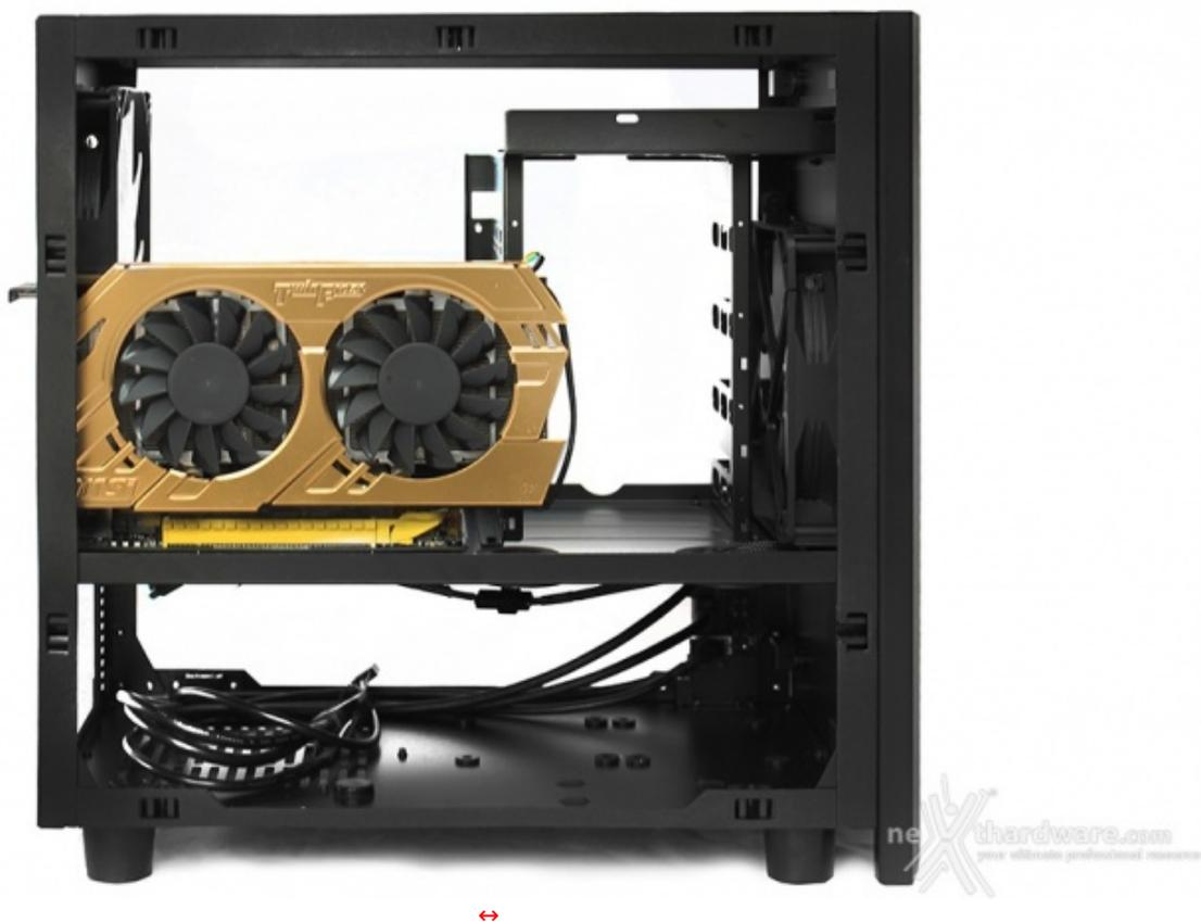
Le dimensioni, dato lo spazio a disposizione, non sono un problema: qualsiasi VGA con dissipatore Dual Slot potrà essere utilizzata.↔
