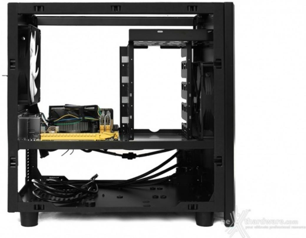
Per l'installazione della scheda video è necessario rimuovere i coprislot PCI agendo sul retro del case.
