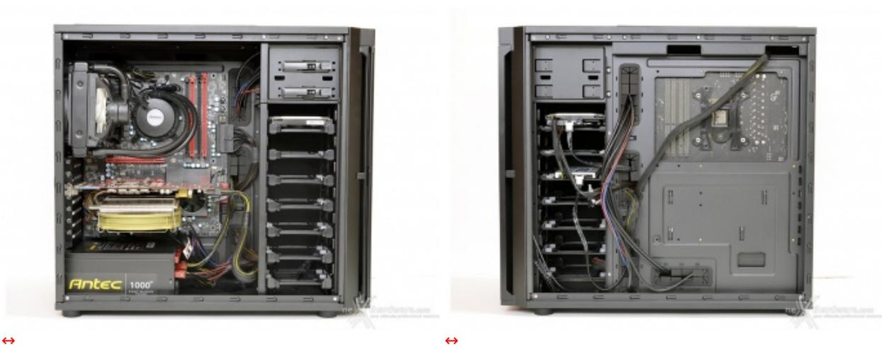
Da ultimo, abbiamo montato il masterizzatore, un Hard Disk ed un SSD con i relativi cavi SATA.
