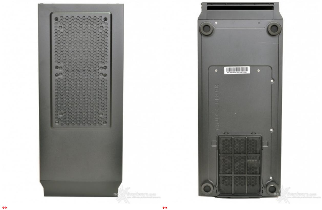
Sul top del case è visibile l'ampia griglia che potrà ospitare due ventole da 120/140mm, oppure un radiatore da 240/280mm.
