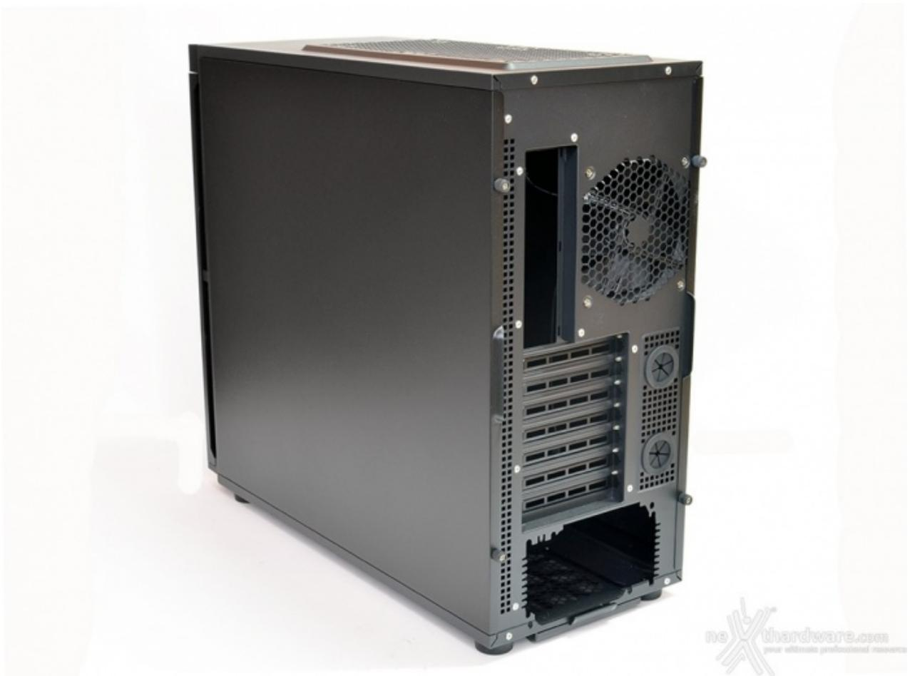
Il retro dell'Antec P100 prevede, oltre alla griglia per la ventola da 120mm, i sette slot di espansione, al cui fianco sono posizionati due fori passatubo con guarnizioni in gomma, ed il vano alimentatore.
