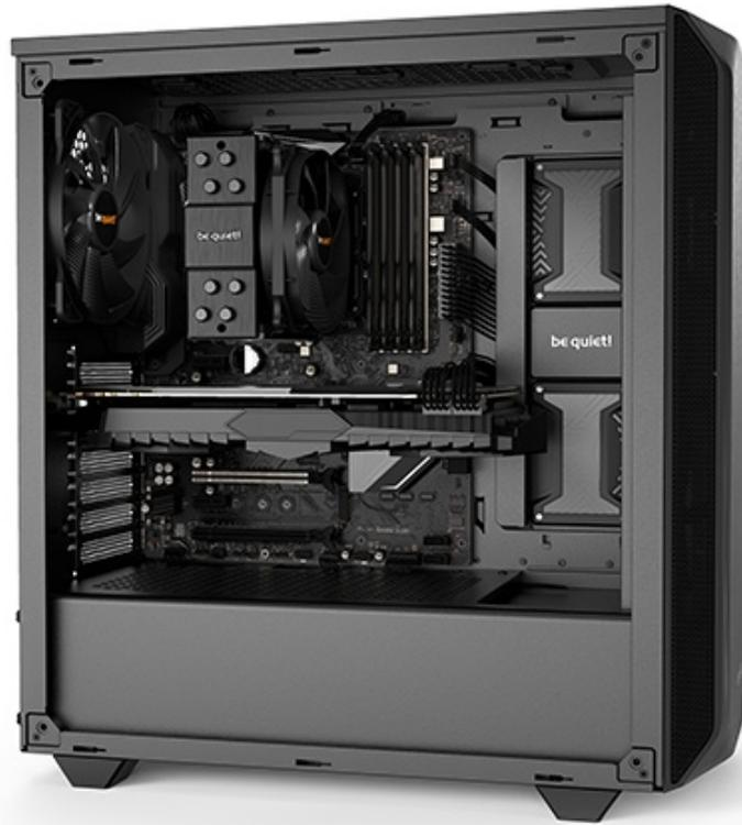
Elevato, anche questa volta, il numero di predisposizioni per ventole che potranno essere tre da 120 o due da 140mm sul frontale, con una da 140mm già presente al momento dell'acquisto, due da 120 o 140mm sul top e una da 120 o 140mm sul retro, anch'essa in dotazione.
