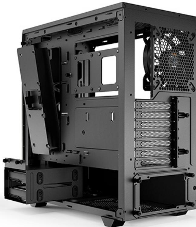
Nonostante le dimensioni molto compatte, di 463x450x231mm (AxPxL), il Pure Base 500 è in grado di contenere una scheda madre in formato ATX, schede video lunghe 369mm, due drive da 3,5" e cinque da
