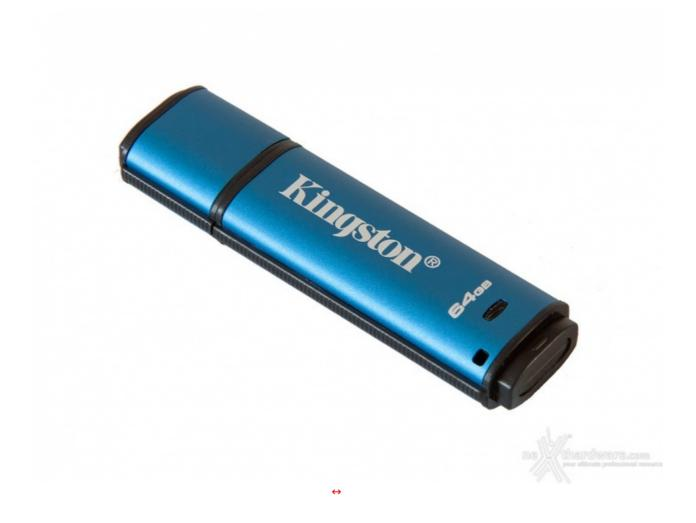
La struttura del⇔ DataTraveler Vault Privacy 3.0 è di tipo tradizionale, con connettore USB fisso e cappuccio di protezione.
