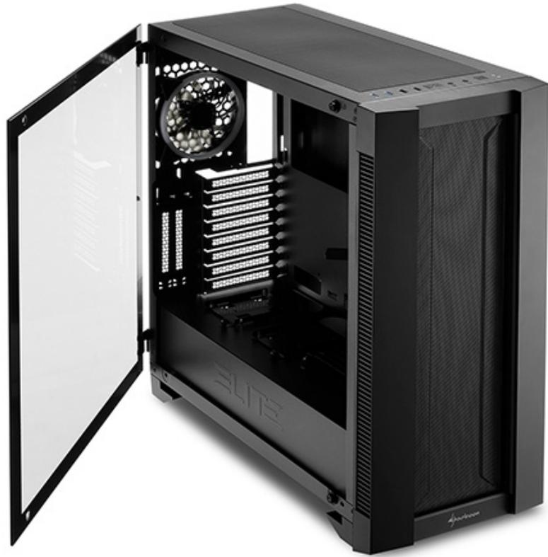
Essendo basati sullo stesso telaio, entrambi i case consentono l'installazione di schede madri sino al formato E-ATX, quattro drive da 3,5" o sette da 2,5", schede video lunghe 425mm (installabili anche in verticale) e dissipatori ad aria alti 165mm.
