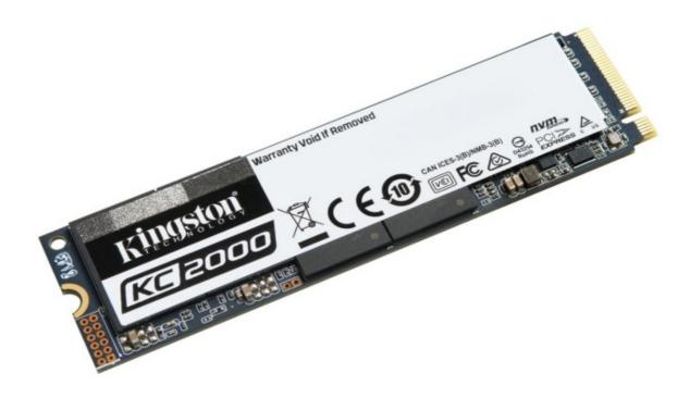
I nuovi KC2000 offrono funzioni di crittografia automatica in hardware AES 256 bit con protezione dei dati end-to-end e consentono l'utilizzo di software di terze parti con supporto allo standard TCG Opal 2.0 come quelli prodotti da Symantec, McAfee e WinMagic, nonché integrano Microsoft eDrive, una specifica di archiviazione di sicurezza da utilizzare con BitLocker.
