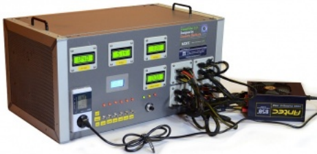
PowerKiller 2.0 Banco progettato per testare alimentatori fino a 2185W
