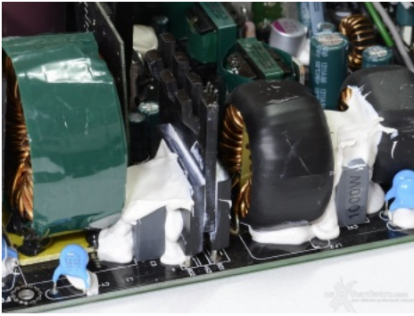
Un primo piano del doppio ponte raddrizzatore.
