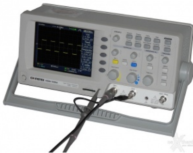
Oscilloscopio: Gw-Instek GDS-1022 • 2 * 25MHz
