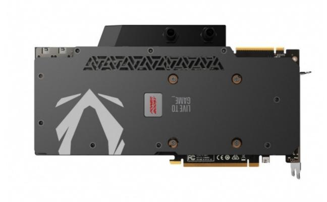
Realizzato in rame con finitura nichelata, il waterblock presenta una struttura a micro-canali da 0,3mm ed è coadiuvato nella sua azione di raffreddamento da un massiccio backplate in metallo.
