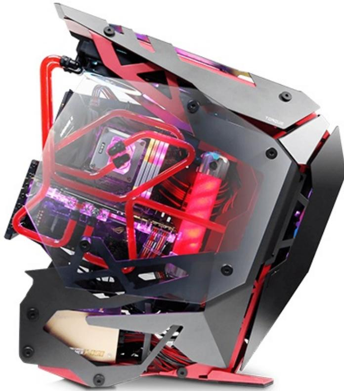
Al suo interno è possibile installare schede madri ATX o inferiori, nonché due radiatori da 360mm con relative ventole lungo il frontale e sul top.
