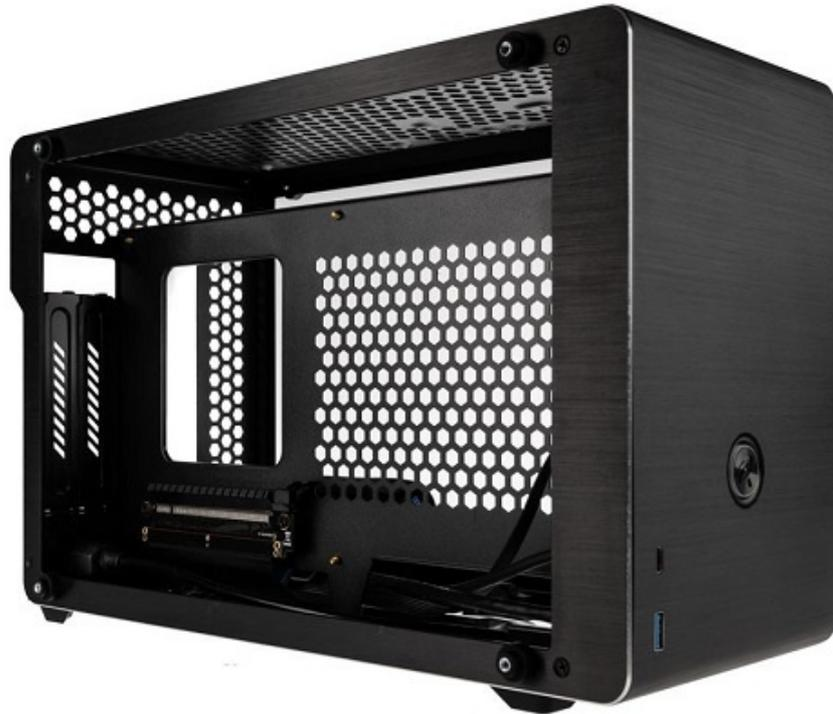
In grado di ospitare schede video lunghe fino a ben 330mm e alimentatori in formato standard ATX, il nuovo Ophion fa dell'ottimizzazione dello spazio il suo punto di forza, risultando poco più grande di una VGA dock esterna.
