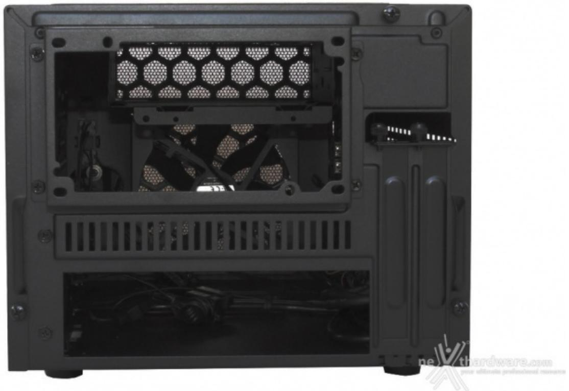
Stando a quanto riportato sul sito ufficiale Cooler Master, in caso di utilizzo di un sistema a liquido All-in-One il supporto dell'alimentatore va smontato e rimontato ruotato di 180°; solo dopo questa breve operazione l'alimentatore potrà essere montato nel verso più adatto, ovvero con la ventola in basso.
