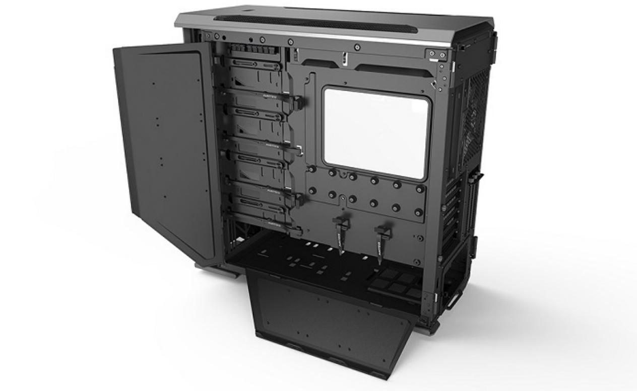
Un'altra interessante novità ↔ è costituita dalla presenza di tre slot per il montaggio verticale delle schede video mentre, per quanto riguarda la compatibilità con i sistemi di raffreddamento a liquido di tipo custom, il nuovo EVOLV X non teme rivali con possibilità di montare radiatori lunghi fino a 420mm sul frontale e 360mm sul top e ospitando, nella parte anteriore, un'uscita dedicata al rabbocco dell'impianto.
