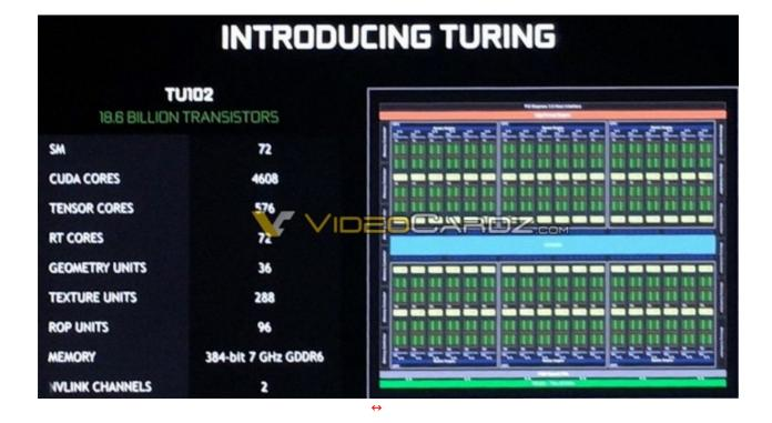
NVIDIA TU102 completo ha 72 SM, 4608 CUDA Core, 576 Tensor core, 72 RT Core, 36 GU, 288 TMU e 96 ROP oltre che un'interfaccia di memoria a 384 bit per il collegamento a 12GB di GDDR6 da 14Gbps, contro 68 SM, 4352 CUDA Core, 544 Tensor Core, 68 RT Core, 34 GU, 272 TMU e 88 ROP presenti sulla GPU della GeForce RTX 2080 Ti che è dotata di un bus a 352 bit per gli 11GB di GDDR6 sempre a 14Gbps.
