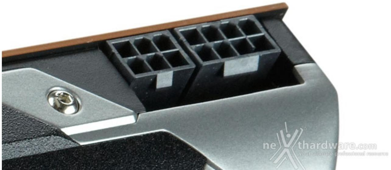
NVIDIA ha lavorato per ottimizzare il carico sulle varie linee di alimentazione, bilanciando l'assorbimento di corrente ed evitando di andare a caricare una specifica connessione (PCI-E 6 pin, PCI-E 8 pin e slot PCI-E 3.0).
