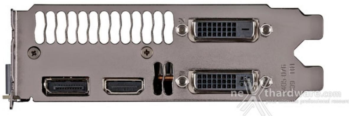
A differenza delle schede video AMD precedenti alla serie R9, non è necessario utilizzare adattatori DisplayPort attivi per poter collegare tre monitor, ma è sufficiente utilizzare le due porte DVI e quella HDMI.
