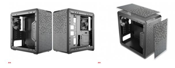
Il Q300L è caratterizzato da un design piuttosto originale e presenta filtri magnetici antipolvere posizionati sul pannello anteriore e superiore.
