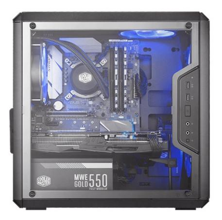
Con dimensioni (PxLxA) di 387x230x378mm per il Q300L e di 450x230x450mm per il Q300P, entrambi in nuovi case potranno ospitare, oltre ad una scheda madre in formato microATX o inferiore, schede video da 360mm, dissipatori ad aria alti 157mm, un radiatore da 240mm, un drive da 3,5", due da 2,5" ed un alimentatori da 160mm.
