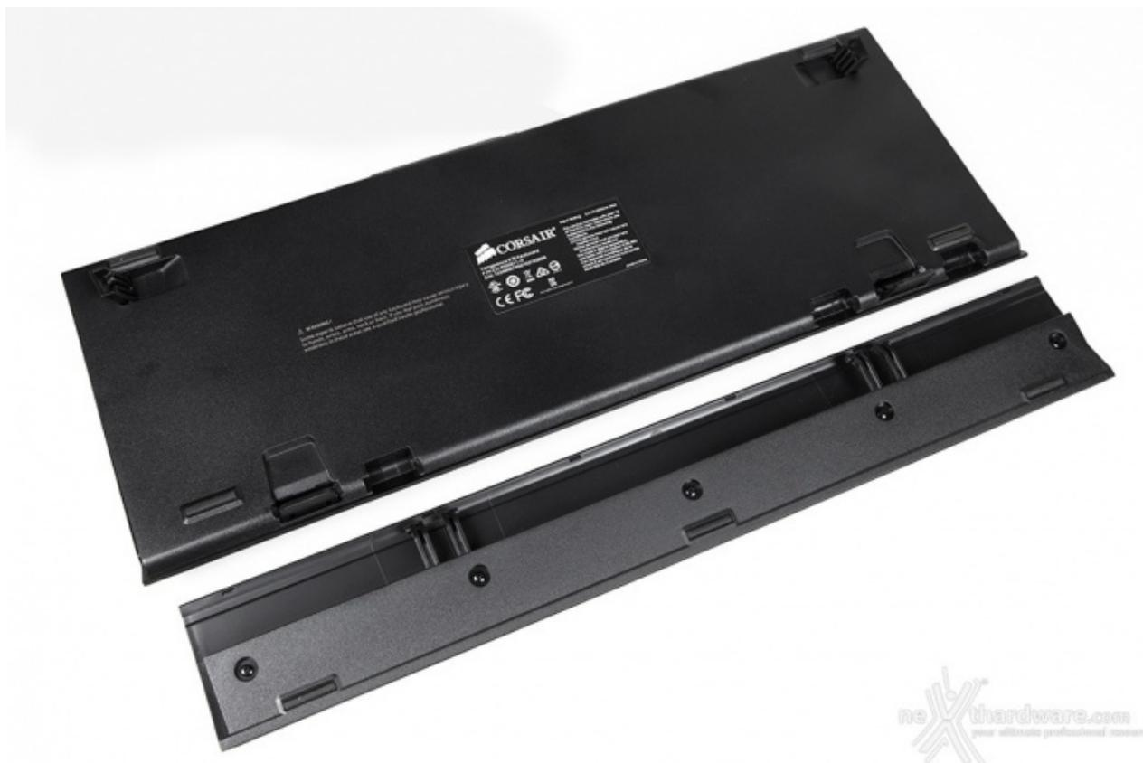
Per il montaggio è sufficiente avvicinare il poggiapolsi alla struttura della tastiera e spingere leggermente per fare in modo che lo stesso si incastri nelle sedi preposte.
