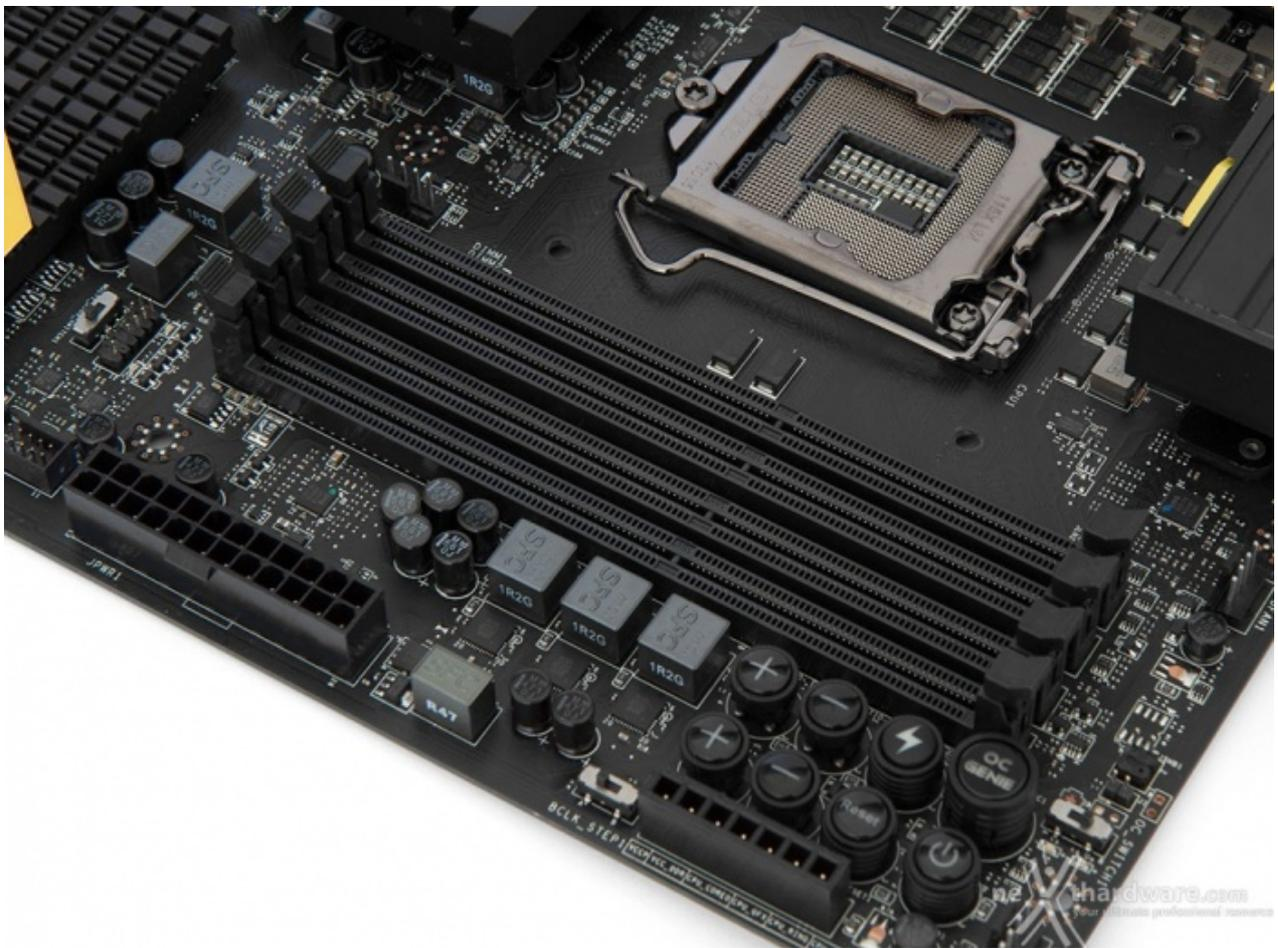
Per la Z87 Xpower MSI adotta la tecnologia **T-Topology**, una particolare disposizione degli slot DIMM in grado di ridurre al minimo il rumore di accoppiamento e la riflessione del segnale, aumentando le capacità di overclock delle RAM.
