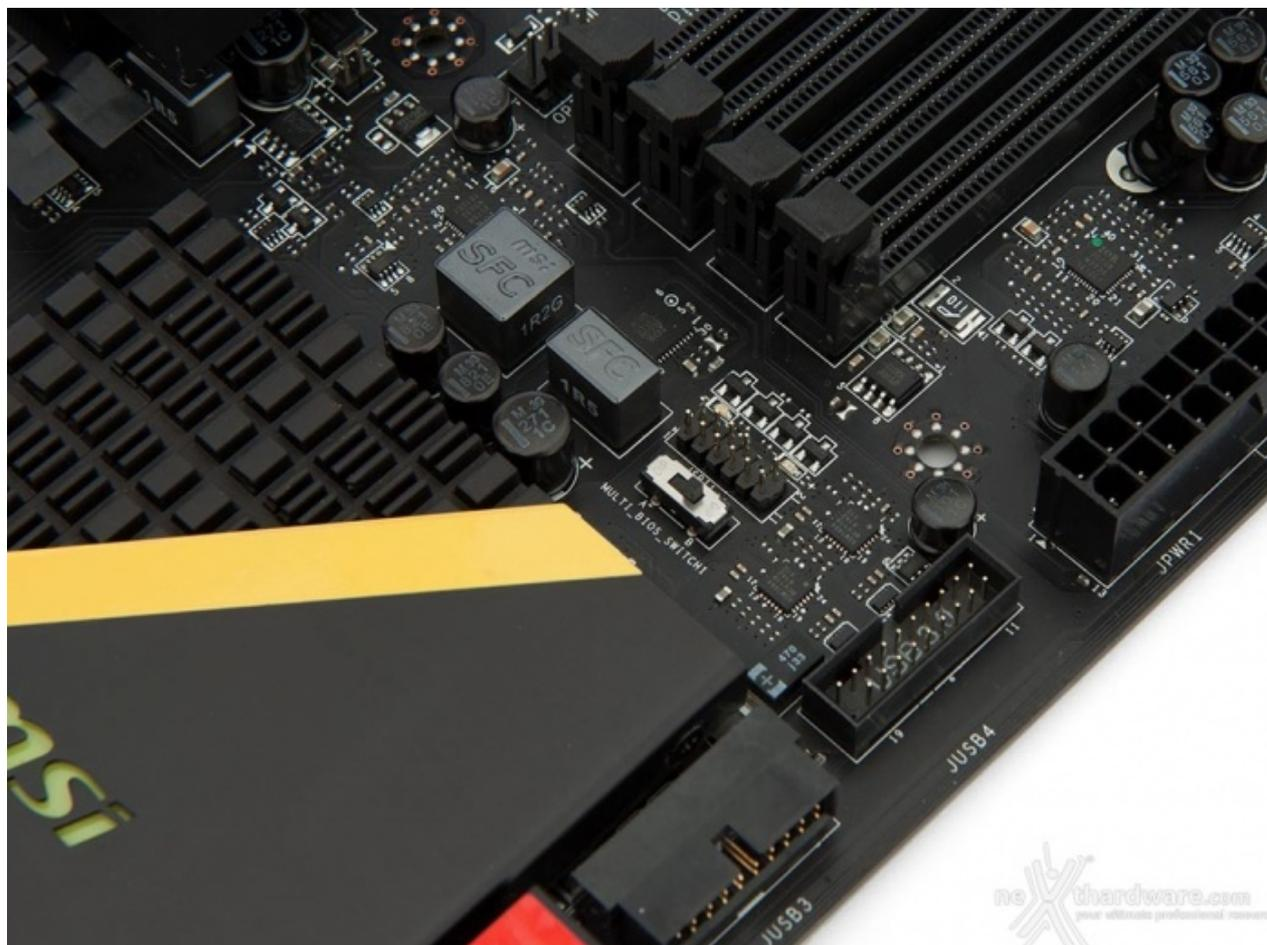
La MSI Z87 Xpower integra due BIOS che possono essere attivati alternativamente attraverso un piccolo selettore posto in prossimità del chipset: due led arancioni, situati nelle immediate vicinanze, segnaleranno quale BIOS è attualmente in uso.
