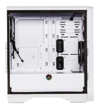
Il Mid Tower, realizzato in plastica, acciaio e vetro temperato, è in grado di contenere una scheda madre in formato E-ATX o inferiore, tre drive da 2,5", due da 3,5", un dissipatore ad aria per CPU alto 160mm e schede video lunghe 340mm.
