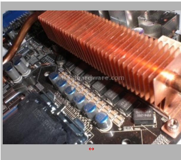
La sezione di alimentazione è estremamente curata, dimensionata in modo da fornire le massime prestazioni anche sotto pesanti overclock.
