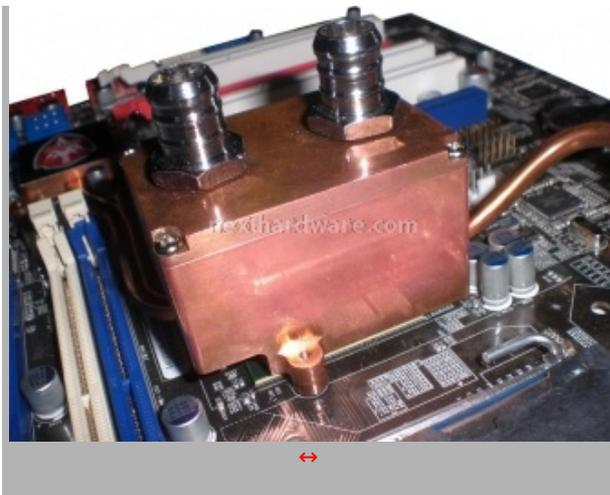
Il dissipatore del chipset è modulare, può ospitare un raffreddamento ad aria oppure a liquido (vedi foto).
