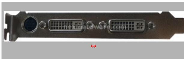
La scheda è dotata di due connettori DVI abilitati HDCP e con la possibilità di veicolare audio multicanale, attraverso un adattatore DVI-HDMI non incluso. è disponibile anche una connessione S-VIDEO/composito.
