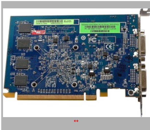
Sul retro della Sapphire HD4550, sono presenti 4 degli 8 moduli di memoria DDR2, che non sono dissipati in alcun modo, la temperatura di esercizio è comunque contenuta con ogni carico di lavoro.
