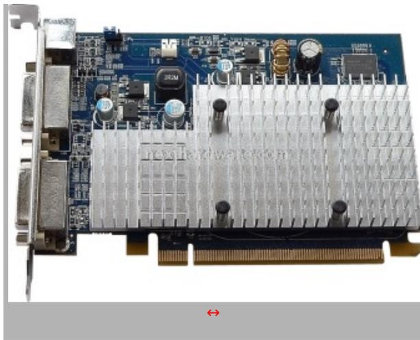
La VGA è dotata di un unico dissipatore passivo in alluminio che ricopre quasi interamente il PCB della stessa. Le temperature di esercizio non sono in assoluto contenute, ma garantiscono in ogni caso, un funzionamento stabile.
