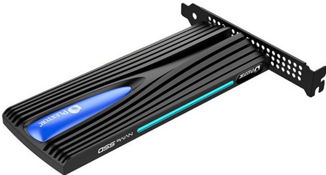
Progettati per competere con la serie Samsung 950 EVO, questi SSD utilizzano NAND Flash TLC Toshiba in abbinamento ad un controller Marvell 88SS1093 ed usufruiscono dell'interfaccia PCI-E gen 3.0 x4 e del protocollo NVMe.
