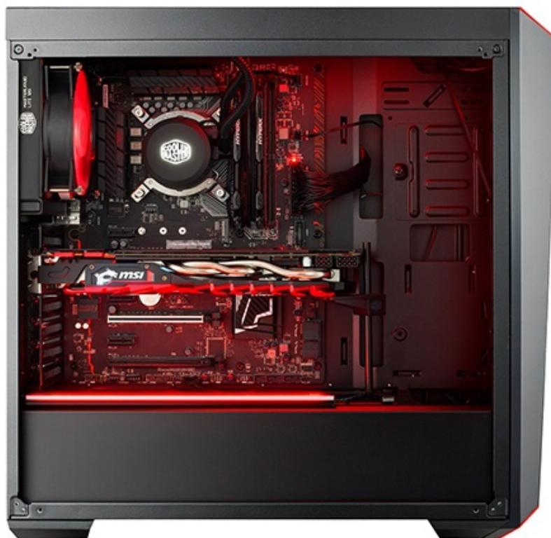
La struttura del Masterbox Lite 5, completamente rivista rispetto a quella del Masterbox 5, permette l'utilizzo di una scheda madre ATX, schede video lunghe sino a 400mm, un buon numero di drive e sistemi di dissipazione di fascia alta, tuttavia Cooler Master non ha rilasciato ulteriori informazioni riguardanti le specifiche tecniche, ma si è limitata, per ora, a promuoverne solo il design.
