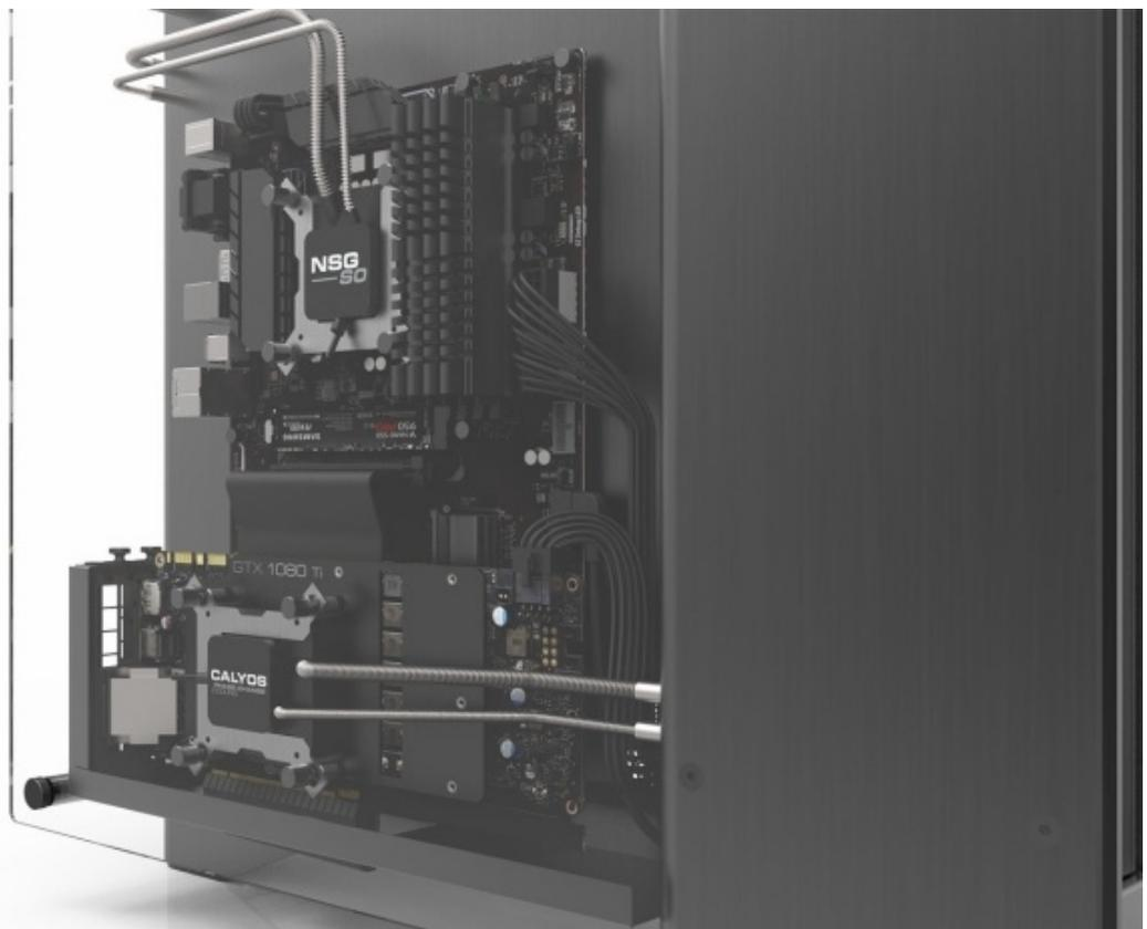
Il case presenta una struttura centrale in alluminio spazzolato che prevede a sinistra il vassoio per l'installazione di mainboard e VGA, mentre a destra quello per l'alimentatore, i drive SATA e, ovviamente, l'unità di raffreddamento a cambiamento di stato o fase (che dir si voglia), il quale convoglia il gas
