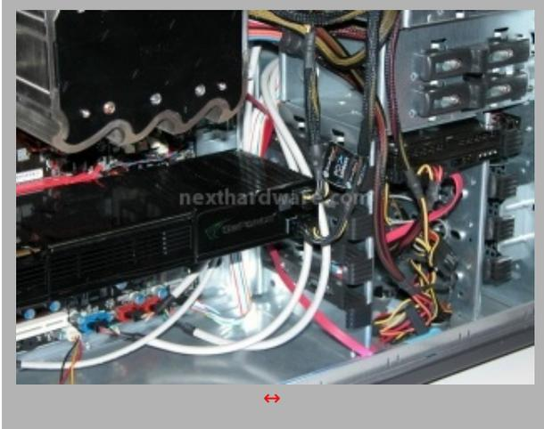
Ecco le prime foto della 9800GX2. La scheda è di generose dimensioni, le due GPU G92 sono installate su 2 PCB distinti e sono rivolte verso l'interno della stessa. Un unico dissipatore si occupa del raffreddamento.
