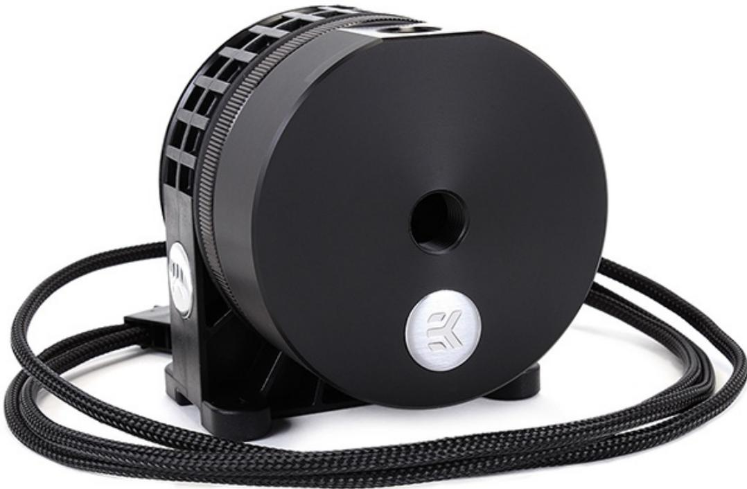
La pompa sarà commercializzata in due varianti, di cui la prima, visibile nella foto in alto, è dotata di top in acetale di colore nero, mentre la seconda con un top in acrilico trasparente.
