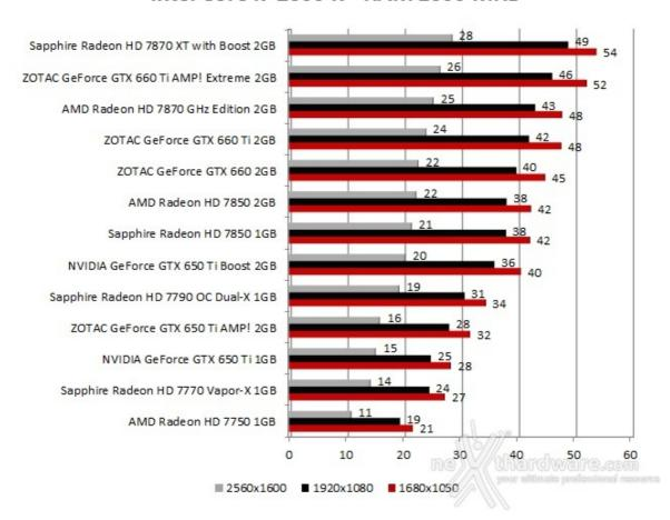
Le prestazioni offerte dalla NVIDIA GeForce GTX 650 Ti Boost sono molto vicine a quelle della AMD Radeon HD 7850 e la distanza tra le varie schede tende a diminuire al crescere della risoluzione.
