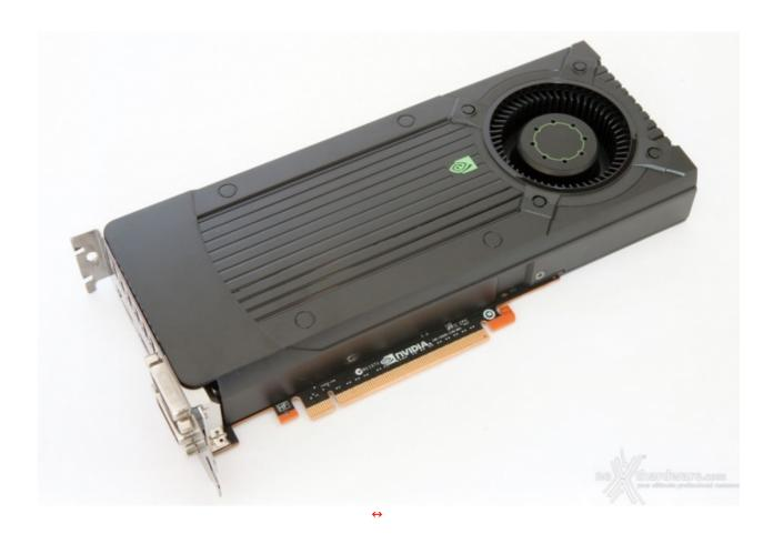
Anche per la GeForce GTX 650 Ti Boost, NVIDIA ha deciso di utilizzare un PCB di dimensioni estremamente contenute (17cm), caratteristica che fino a poco tempo fa era riservata alle sole schede video di fascia medio/bassa.
