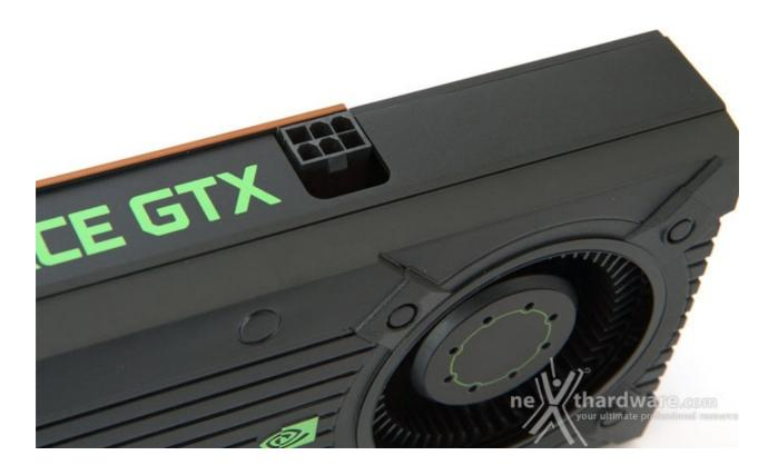
Per alimentare la GeForce GTX 650 Ti Boost è necessario collegare un cavo di alimentazione PCI-E 6 pin. Il Thermal Design Power (TDP) è di 134W, 24W in più della sorella minore ed 8W in meno della GeForce GTX 660.
