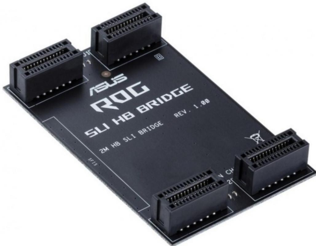
I nuovi bridge High Bandwidth di ASUS hanno una lunghezza di 60mm con spaziatura per due slot così da consentire il montaggio di due VGA senza che siano troppo vicine tra loro garantendo un raffreddamento migliore, specialmente se lasciate ad aria ed in presenza di dissipatori di generose dimensioni.
