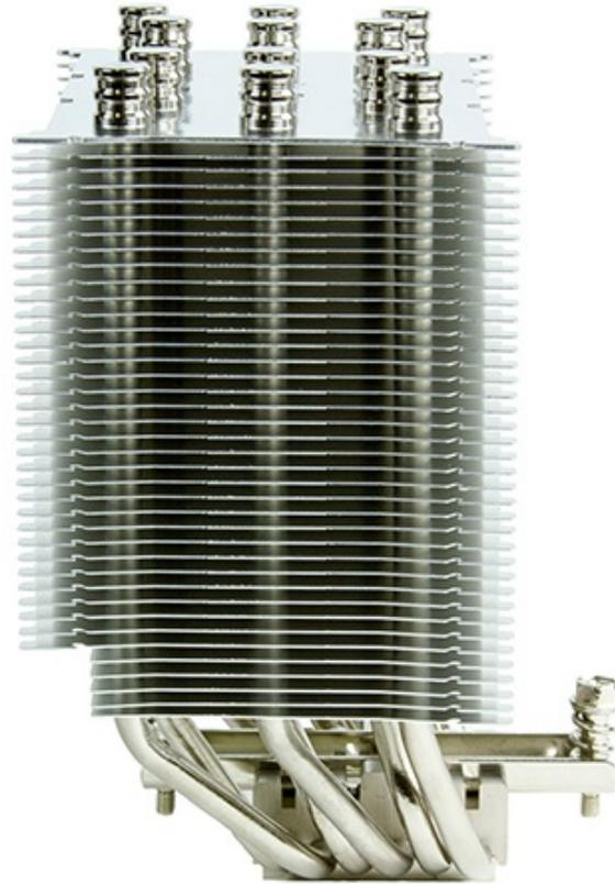
Il corpo dissipante, alto solo 154.5mm, è composto da tante alette in alluminio di generose dimensioni ed è spostato rispetto all'asse verticale per garantirne la compatibilità con moduli di RAM ad alto profilo.
