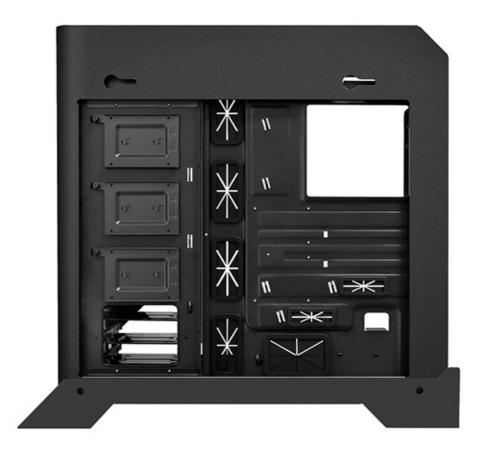
Seguendo l'attuale tendenza, il GIGABYTE Xtreme Gaming XC700W è sprovvisto di bay da 5,25", ma contiene un cestello per tre drive da 3,5" o 2,5" ed offre la possibilità di installare tre ulteriori unità da 2,5"
