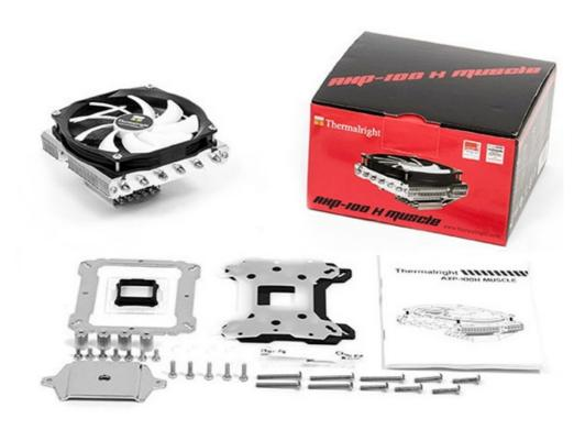
Il corpo lamellare composto da 40 unità in alluminio, dissipabile attivamente attraverso una performante e silenziosa ventola True Spirit 140 Direct in dotazione, è collegato alla base tramite sei heatpipes da 6mm di diametro.
