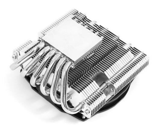
La zona dissipante è stata sollevata rispetto alla base, di circa 7mm garantendo, quindi, la compatibilità con la suddetta mainboard ma, allo stesso tempo, non alterandone in modo significativo l'altezza complessiva, che è di soli 51mm senza la ventola o 65mm ventola inclusa.
