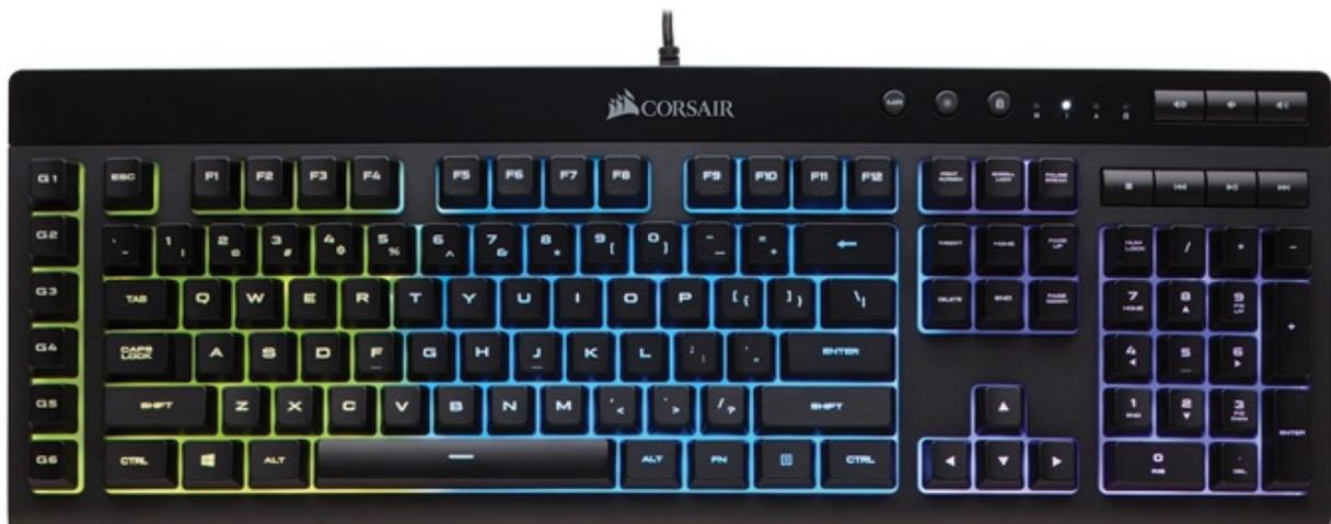
La K55 RGB sarà dotata di una matrice dei tasti con supporto antighosting ed un Key Rollover limitato a "tasti multipli", ovvero quelli maggiormente utilizzati dai giocatori, mentre il sistema di illuminazione, che può contare su LED singoli per ogni tasto, è gestito in 3 zone con 10 effetti preconfigurati.
