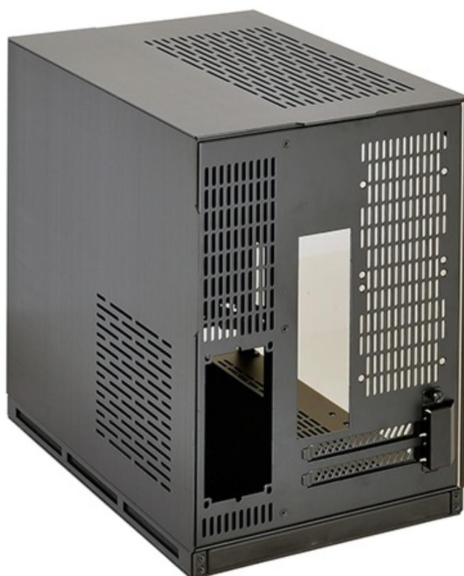
Altre due ventole da 120mm possono essere montate sulla base del case, mentre due unità da 80mm possono trovar spazio su una griglia posizionata nei pressi del foro per l'I/O shield.
