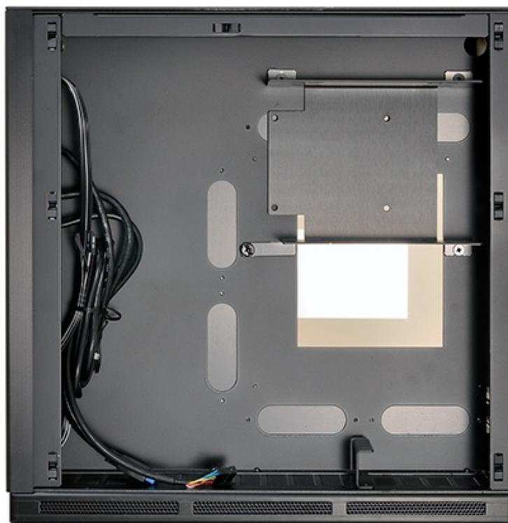
Lo spazio retrostante il piatto mainboard, ovvero il vano destro, è adibito all'installazione di un alimentatore SFX o SFX-L (con lunghezza massima di 220mm) e di tre drive, di cui due da 3,5" uno da 2,5" all'interno di un apposito cestello removibile.
