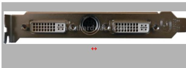
Sulla scheda sono presenti due connessioni DVI con supporto per l'audio multicanale da utilizzare in abbinamento al convertitore DVI/HDMI incluso nella confezione. E' inoltre disponibile un connettore per il collegamento del cavo component e composito.
