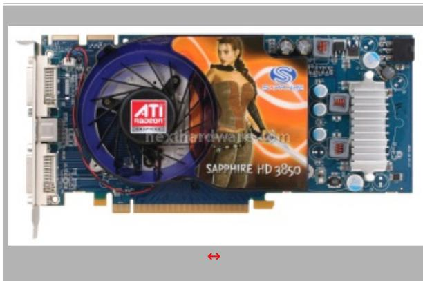
Il dissipatore dedicato al raffreddamento della GPU e delle RAM, è dotato di una ventola da 80x80mm, alettatura in alluminio e due heatpipe per accelerare lo scambio termico.
