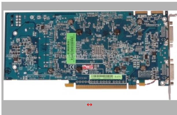
Sul retro della VGA spicca il logo HDCP, a sottolineare la compatibilità con questa tecnologia di protezione dei contenuti in alta definizione. In alto a destra si possono vedere i due connettori per la modalità CrossFireX che permette di sfruttare fino a 4 GPU contemporaneamente (attualmente non sono ancora stati rilasciati driver in grado di lavorare in questa modalità).
