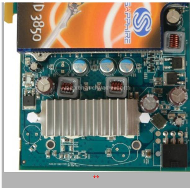
Sapphire ha dedicato particolare cura nella costruzione del circuito di alimentazione di questa scheda video, i piccoli mosfet sono sovrastati da un dissipatore di alluminio e gli altri componenti discreti sono di buona qualità .
